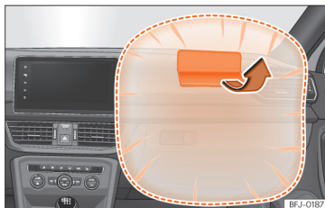
Abb. 16 Beifahrerairbag in der Instrumententafel
