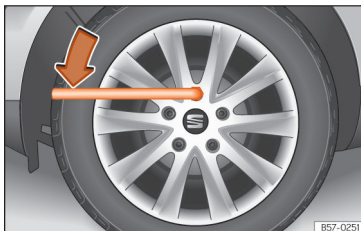
Abb. 35 Radwechsel: Radschrauben lockern.
