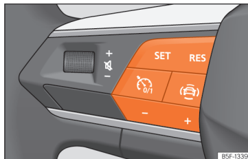
Abb. 182 Am Multifunktionslenkrad: Tasten zum Bedienen des Geschwindigkeitsbegrenzers
