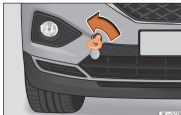
Abb. 46 Auf der rechten Seite des vorderen Stoßfängers: eingeschraubte Abschleppöse.
