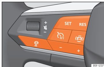
Abb. 186 Am Multifunktionslenkrad: Tasten zur ACC-Bedienung
