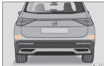
Abb. 178 Heckansicht des Fahrzeugs: Bereiche der Radarsensoren.
