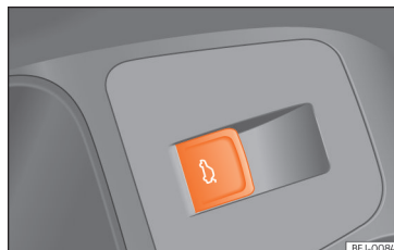
Abb. 86 An der Fahrertür: Taste zum Öffnen und Schließen der Heckklappe.
