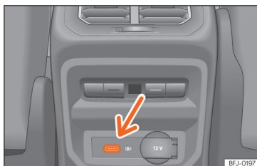
Abb. 163 Mittelkonsole hinten: USB-Anschlüsse mit Steckdosenfunktion.
