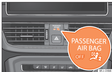
Abb. 18 Instrumententafel: Kontrollleuchte für Abschaltung des Beifahrerairbags.
