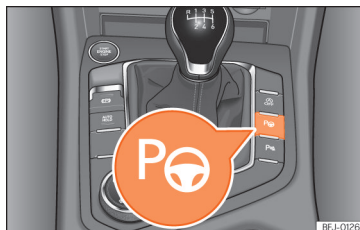
Abb. 202 Im oberen Teil der Mittelkonsole: Taste zum Einschalten des Parklenkassistenten.
