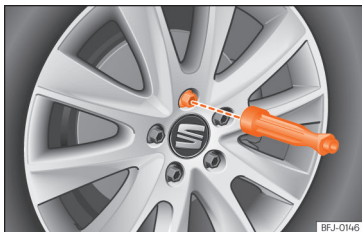
Abb. 39 Radwechsel: Radschrauben mit dem Schraubendrehergriff herausdrehen.
