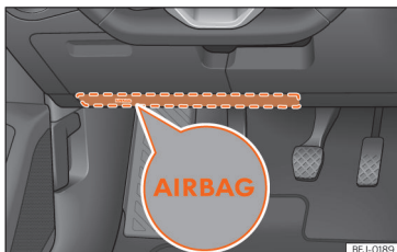
Abb. 19 Auf der Fahrerseite: Einbauort des Knieairbags.
