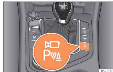
Abb. 216 Mittelkonsole: Taste zum manuellen Aktivieren und Deaktivieren der Rundumsicht in Verbindung mit dem Parklenkassistent.
