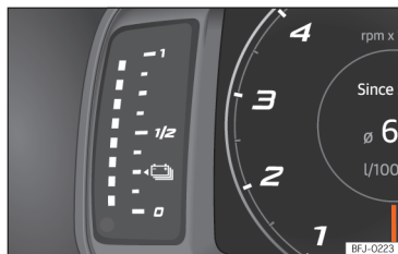
Abb. 60 Kombi-Instrument: Anzeige des Batterieladezustands.
