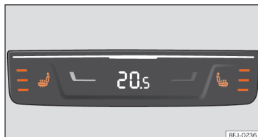
Abb. 151 In der Mittelkonsole hinten: Bedienelemente für die Sitzheizung der Rücksitze.
