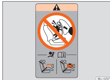
Abb. 25 Airbagaufkleber: Im hinteren Rahmen der Beifahrertür
