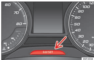
Abb. 111 Kombi-Instrument: Kilometerzähler und Rückstelltaste.
