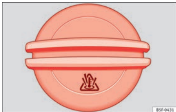
Abb. 51 Motorraum: Deckel des Motorkühl- mittelausgleichsbehälters
