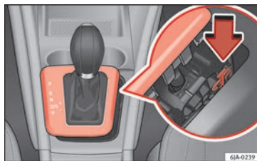
Abb. 44 Notentriegeln der Wählhebelsperre
