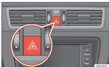
Abb. 29 Instrumententafel: Schalter für die Warnblinkanlage
