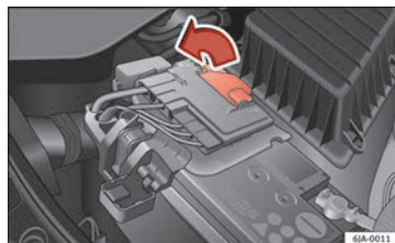
Abb. 211 Batterie: Öffnen der Abdeckung
