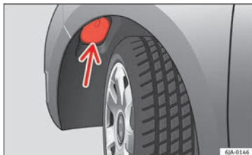
Abb. 91 Lampe für Ablendlicht wechseln: Radkasten
