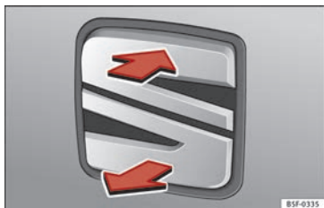
Abb. 126 Heckklappe: Öffnen von außen
