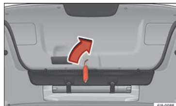
Abb. 6 Ausschnitt Gepäckraum: Zugang zur Notentriegelung
