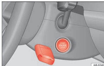
Abb. 174 Notstart bei Fahrzeugen mit Keyless Access.
