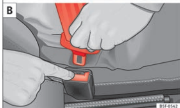
Abb. 78 Schlosszunge des Sicherheitsgurts in das Gurtschloss einstecken und vom Gurtschloss lösen.
