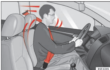
Abb. 75 Richtig angelegte Fahrer werden bei einem plötzlichen Bremsmanöver nicht nach vorne geschleudert.
