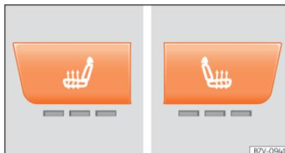
**Abb. 159** Ausschnitt aus der Mittelkonsole: Regler für die Sitzheizung der Vordersitze in Fahrzeugen mit Climatronic.
