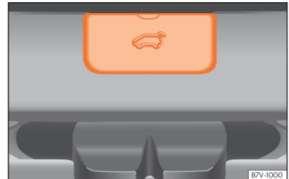
**Abb. 10** Vom Gepäckraum aus: Demontage der Abdeckung der Heckklappe.
