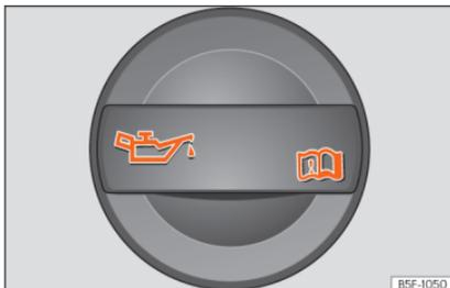
**Abb. 292** Im Motorraum: Deckel der Motoröleinfüllöffnung.
