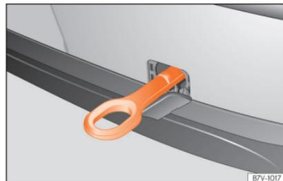
**Abb. 106** Im Stoßfänger hinten rechts: eingeschraubte Abschleppöse.
