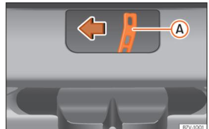
**Abb. 11** Vom Gepäckraum aus: Heckklappe notentriegeln.
