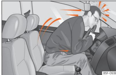
**Abb. 87** Der nicht angegurtete Fahrer schleudert nach vorn.
