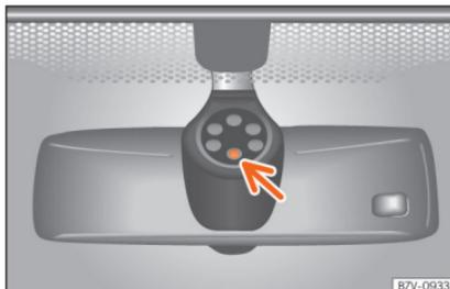
**Abb. 149** Sensitive Fläche des Regensensors.
