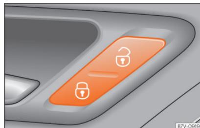
Abb. 132 An der Fahrertür: Zentralverriegelungstaster.
