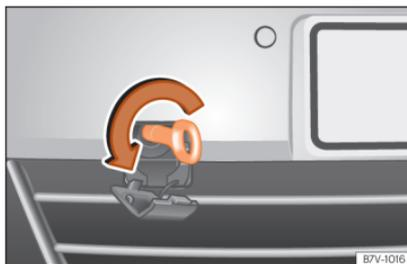
**Abb. 105** Im Stoßfänger vorn rechts: Abschleppöse einschrauben.
