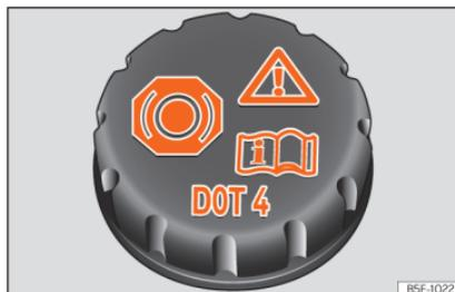
**Abb. 296** Im Motorraum: Deckel des Bremsflüssigkeitsbehälters
