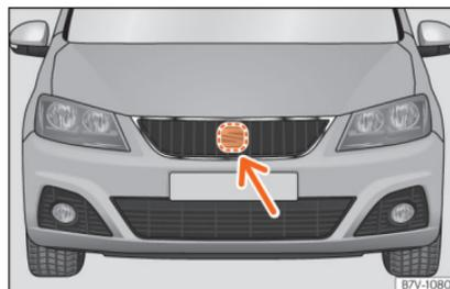
**Abb. 259** Im Frontbereich hinter dem SEAT-Emblem: Radarsensor.
