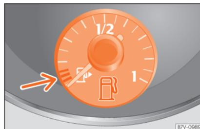
**Abb. 285** Im Kombiinstrument: Kraftstoffvorratsanzeige für Benzin und Diesel.
