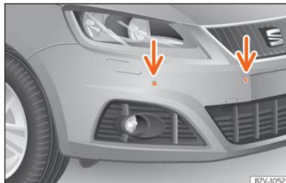
**Abb. 247** Sensoren der Parkdistanzkontrolle vorn im Stoßfänger.
