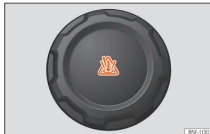
**Abb. 58** Motorraum: Deckel des Motorkühlmittelausgleichsbehälters
