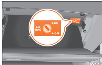
Abb. 94 Im Handschuhfach, auf der Beifahrerseite: Schüsselschalter zum Ab- und Einschalten des Beifahrer-Frontairbags.
