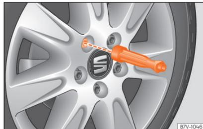
**Abb. 73** Radwechsel: Radschrauben mit dem Schraubendrehergriff abschrauben.
