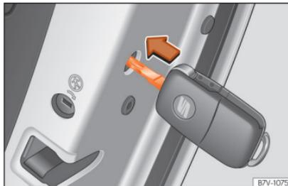
**Abb. 7** Notverriegelung des Fahrzeugs mit dem Fahrzeugschlüssel.
