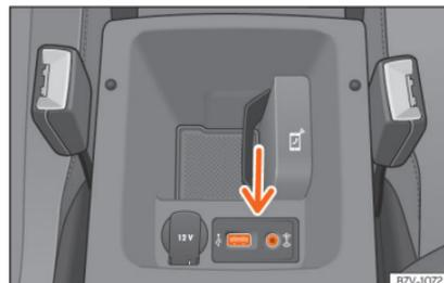
Abb. 218 Mittelarmlehne vorne: USB/AUX-IN Anschluss.
