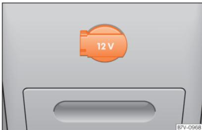
**Abb. 197** Hintere Seite der Mittelkonsole: 12-Volt-Steckdose.
