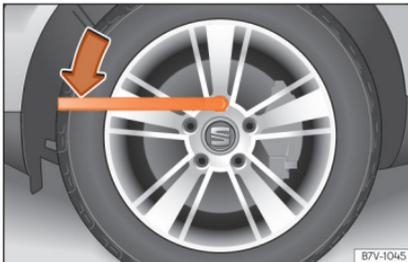
Abb. 69 Radwechsel: Radschrauben lockern.
