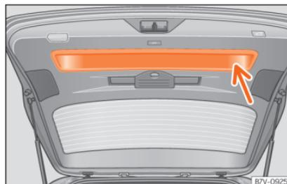
Abb. 139 Offene Heckklappe: Griffmulde zum Zuziehen
