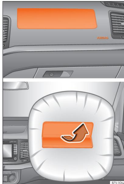
**Abb. 28** Einbauort und Wirkungsbereich des Beifahrer-Frontairbags.
