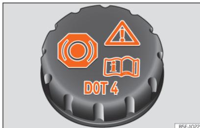
**Abb. 59** Motorraum: Deckel des Bremsflüssigkeitsbehälters
