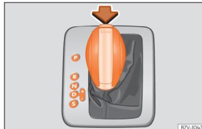
**Abb. 51** Automatisches Getriebe: Wählhebelleistellungen.
