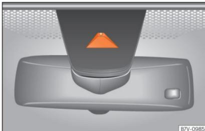
**Abb. 268** An der Frontscheibe: Kameransichtfenster des Spurhalteassistenten.
