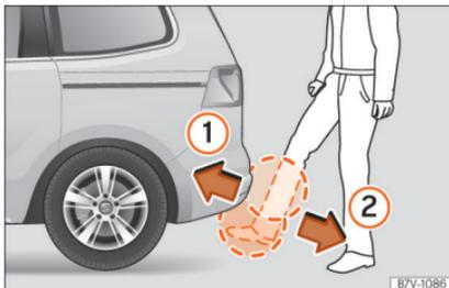
**Abb. 142** Heckklappe mit sensorgesteuerter Öffnung (Easy Open).
