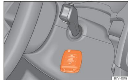
**Abb. 238** Notstart bei Fahrzeugen mit Keyless Access.
