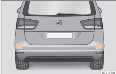
**Abb. 272** Bereich hinter dem Fahrzeug: Bereiche der Radarsensoren.
