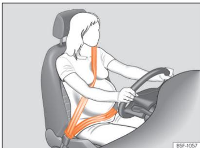
**Abb. 90** Gurtbandverlauf bei schwangeren Frauen.
