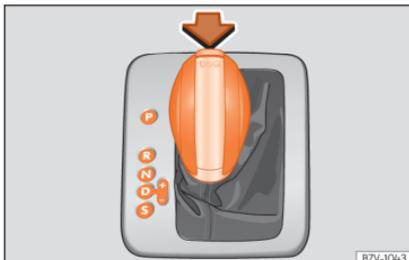
Abb. 241 Wählhebel des automatischen Getriebes mit Sperrtaste (Pfeil).
