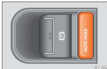
**Abb. 245** Ausschnitt aus der Mittelkonsole: Taster für Auto Hold
