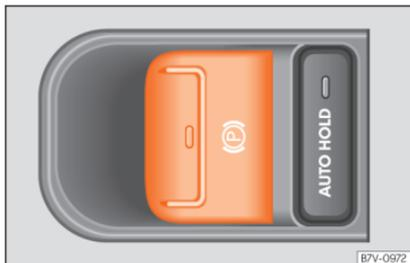
**Abb. 239** Detail der Mittelkonsole: Schalter für elektronische Parkbremse.
