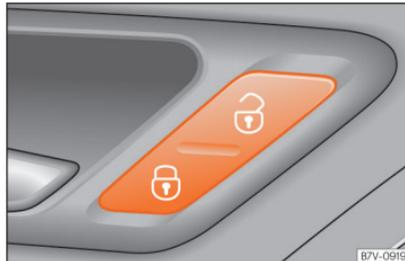
Abb. 4 An der Fahrertür: Zentralverriegelungstaster.
