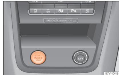
**Abb. 237** In der Mittelkonsole: Starterknopf des schlüssellosen Schließ- und Startsystem Keyless Access. Bei Rechtslenker-Fahrzeugen ist die Anordnung symmetrisch.
