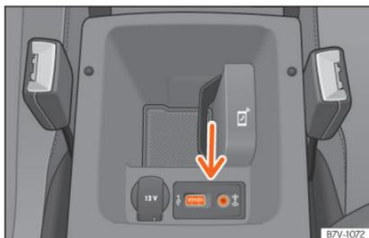
**Abb. 123** Mittelarmlehne vorne: USB/AUX-IN Anschluss.
