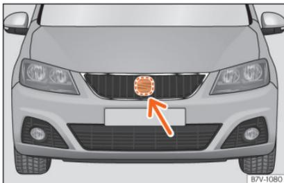
**Abb. 263** Im Frontbereich hinter dem SEAT-Emblem: Radarsensor.
