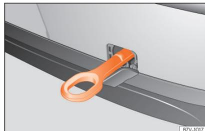
Abb. 75 Im Stoßfänger hinten rechts: eingeschraubte Abschleppöse.
