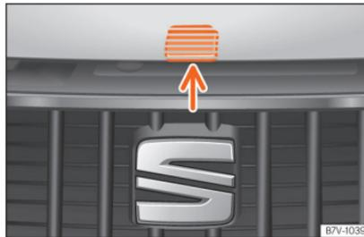
**Abb. 13** Hebel unter der Motorraumklappe.
