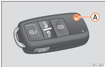
Abb. 127 Fahrzeugschlüssel bei Fahrzeugen mit elektrischen Schiebetüren.
