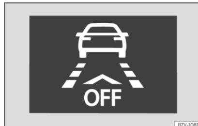
**Abb. 260** Auf dem Display des Kombi-Instrumentes: Anzeige, dass Front Assist ausgeschaltet ist.
