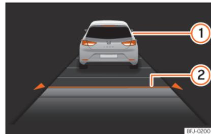
**Abb. 181** Am Bildschirm des Kombi-Instruments: ACC aktiv.
