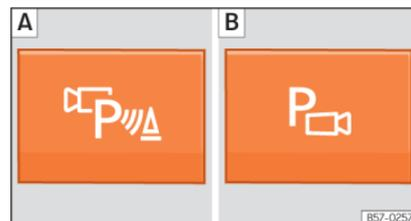
**Abb. 210** Mittelkonsole: Taste zum manuellen Aktivieren und Deaktivieren der Rundumsicht in Verbindung mit dem Parklenkassistenten (A) oder mit dem hinteren ParkPilot (B).
