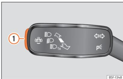
**Abb. 77** Am Blinker- und Fernlichthebel: Taste für die Fahrerassistenzsysteme (modellabhängig).
