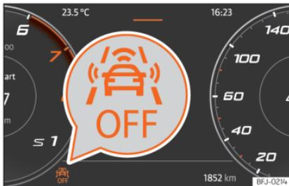
**Abb. 178** Am Bildschirm des Kombi-Instruments: Anzeige, dass Front Assist ausgeschaltet ist.
