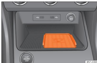
**Abb. 154** In der Mittelkonsole: Aufnahme für die Mobiltelefonkopplung.
