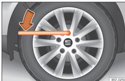
**Abb. 36** Radwechsel: Radschrauben lockern.
