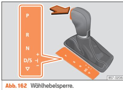
Abb. 162 Wählhebelsperre.
