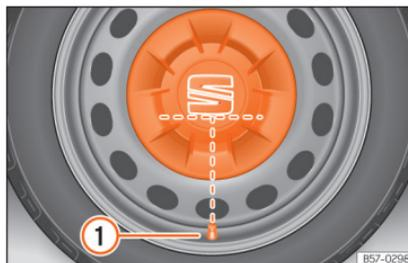
**Abb. 33** Korrekte Anbringung der Radvollblende für Stahlfelgen.
