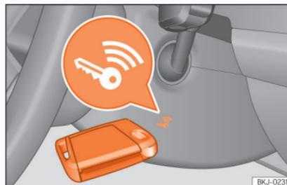
Abb. 159 Rechts an der Lenksäule: Notstart.
