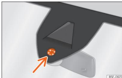
**Abb. 147** Feuchtigkeits- und Temperatursensor der Windschutzscheibe.
