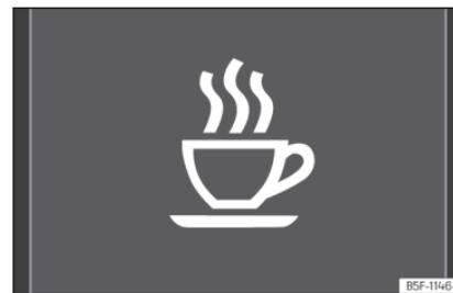
**Abb. 69** Am Bildschirm des Kombi-Instruments: Symbol für Müdigkeitserkennung.
