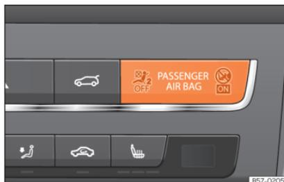
**Abb. 17** Instrumententafel: Kontrollleuchte für Abschaltung der Beifahrerairbags.
