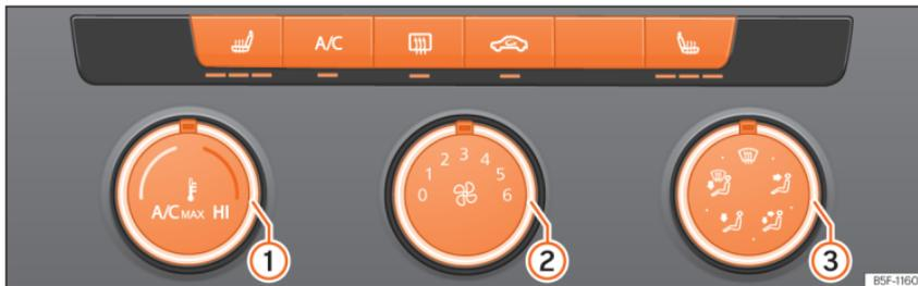
**Abb. 146** In der Mittelkonsole: Bedienungselemente für die Klimaanlage.
