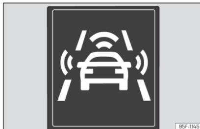
Abb. 177 Am Bildschirm des Kombi-Instruments: Anzeige der Vorwarnung.
