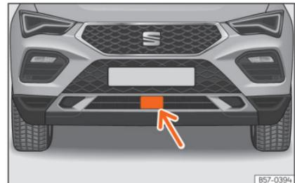
**Abb. 167** Am vorderen Stoßfänger: Radarsensor.
