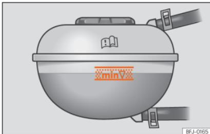
**Abb. 224** Im Motorraum: Markierung an dem Motorkühlmittelausgleichsbehälter.
