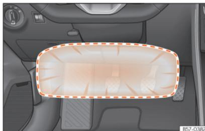
**Abb. 19** Auf der Fahrerseite: Wirkungsbereich des Knieairbags.
