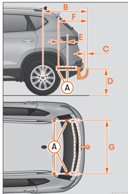
**Abb. 215** Maße und Befestigungspunkte für den nachträglichen Einbau einer Anhängervorrichtung
