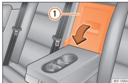
**Abb. 136** An der Rücksitzlehne: Öffnung der Durchladeeinrichtung.
