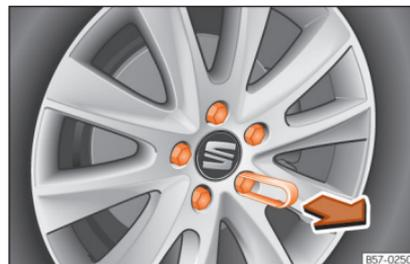
**Abb. 34** Rad: Radschrauben mit Deckel.
