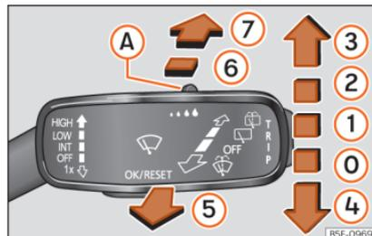
**Abb. 112** Bedienung von Windschutz- und Heckscheibenwischer**Hebel in die gewünschte Position bewegen:**
