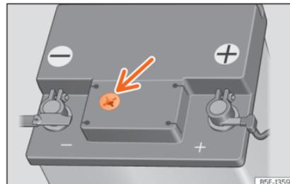
Abb. 228 Sichtfenster an der Oberseite der 12-Volt-Fahrzeugbatterie (Prinzipdarstellung).
