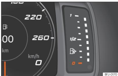
**Abb. 72** Frei konfigurierbares Kombiinstrument: Kraftstoffvorratsanzeige
