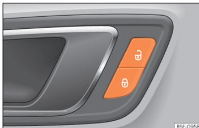
**Abb. 90** Fahrertür: Zentralverriegelungstaster.
