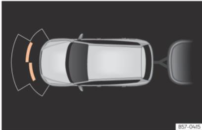
**Abb. 205** Bildschirmanzeige der Einparkhilfe im Anhängerbetrieb.
