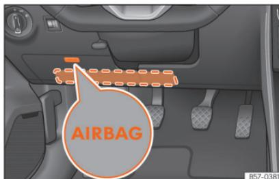
**Abb. 18** Auf der Fahrerseite: Einbauort des Knieairbags.
