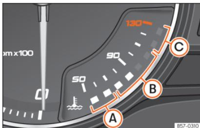
**Abb. 73** Analoges Kombi-Instrument: Motorkühlmittel-Temperaturanzeige.
