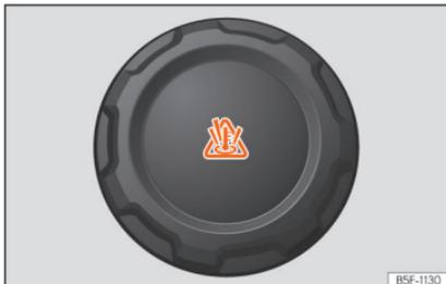
**Abb. 225** Motorraum: Deckel des Motorkühlmittelausgleichsbehälters.
