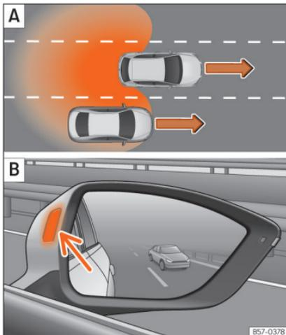
**Abb. 192** Schematische Darstellung: **A** Überholvorgang und anschließender Wechsel auf die rechte Fahrbahn. **B** Anzeige des Spurwechselsassistenten im Außenspiegel rechts.
