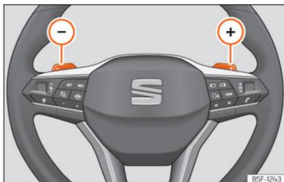
Abb. 164 Lenkrad: Hebel für Automatikgetriebe.
