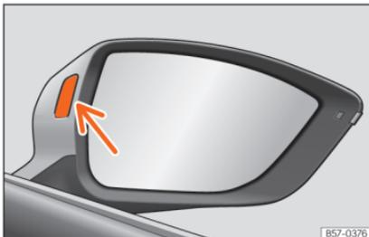
**Abb. 190** Kontrollleuchte des Spurwechselassistenten.
