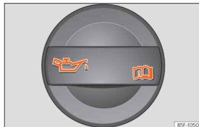
Abb. 223 Deckel der Motoröl-Einfüllöffnung im Motorraum
