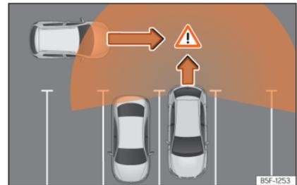
**Abb. 193** Schematische Abbildung des Ausparkassistenten: Überwachter Bereich des ausparkenden Fahrzeugs.
