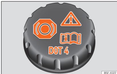
**Abb. 226** Motorraum: Deckel des Bremsflüssigkeitsbehälters.
