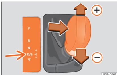
Abb. 163 Hebel in Tiptronic-Stellung.
