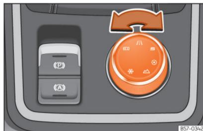
**Abb. 166** Mittelkonsole: Drehknopf [Driving Experience button].
