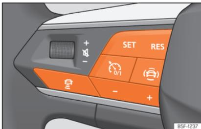
**Abb. 180** Am Multifunktionslenkrad: Tasten zur ACC-Bedienung
