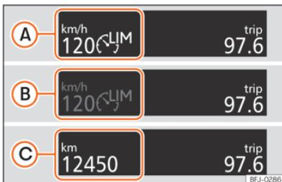
**Abb. 175** Am Bildschirm des Kombi-Instruments: Statusanzeigen des Geschwindigkeitsbegrenzers.
