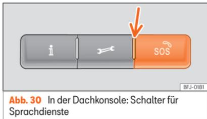
**Abb. 30** In der Dachkonsole: Schalter für Sprachdienste
