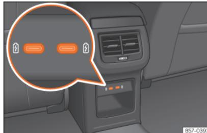
**Abb. 156** Mittelkonsole hinten: USB-Anschlüsse mit Steckdosenfunktion.
