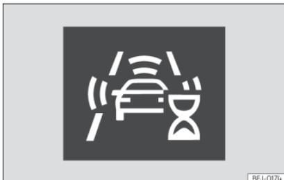
**Abb. 179** Am Bildschirm des Kombi-Instruments: Anzeige der ersten Selbstkalibrierung des Systems.
