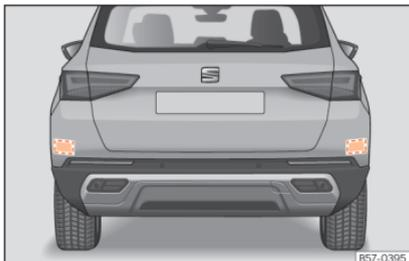
**Abb. 170** Heckansicht des Fahrzeugs: Bereiche der Radarsensoren.
