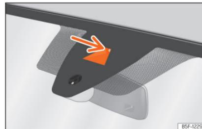
**Abb. 169** An der Windschutzscheibe: Kamerasichtfenster des Spurhalteassistenten.
