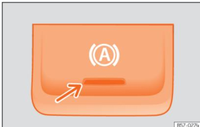
**Abb. 195** Im unteren Teil der Mittelkonsole: Taste für die Auto Hold-Funktion.
