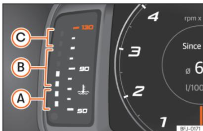
**Abb. 74** Frei konfigurierbares Kombiinstrument: Motorkühlmittel-Temperaturanzeige.
