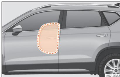
Abb. 21 Komplettaufgeblasene Seitenairbags auf der linken Fahrzeugseite
