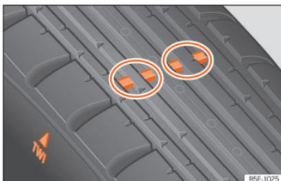
Abb. 230 Reifenprofil: Verschleißanzeiger.
