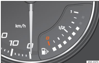
**Abb. 71** Analoges Kombi-Instrument: Kraftstoffvorratsanzeige
