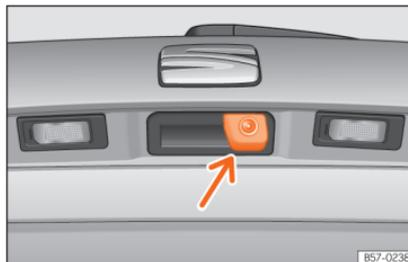
**Abb. 172** Im Griff der Heckklappe: Umgebungsansicht.
