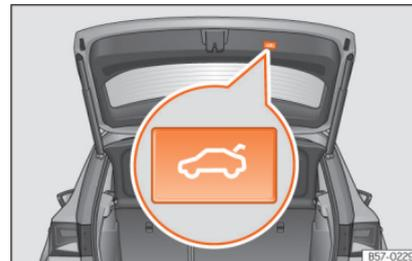
**Abb. 98** Heckklappe: Taste zum Schließen der Heckklappe.
