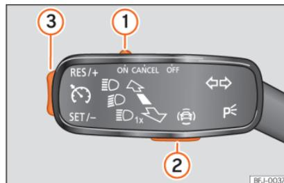
**Abb. 176** Am Blinkerhebel: Tasten zur Bedienung des Geschwindigkeitsbegrenzers.
