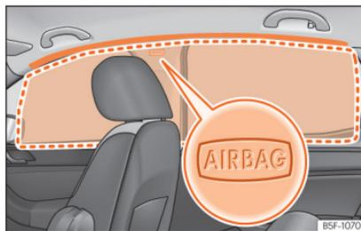
Abb. 22 Einbauort der Kopfairbags
