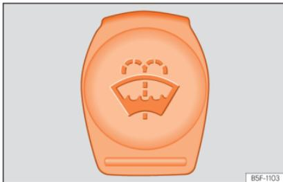
**Abb. 227** Im Motorraum: Deckel des Scheibenwaschbehälters.
