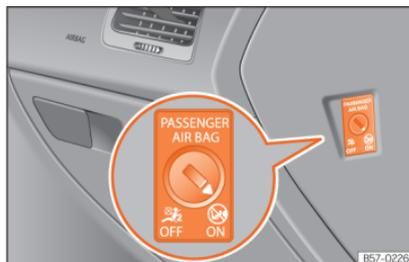
**Abb. 16** Schlüsselhalter zum Ein- und Abschalten des Beifahrerairbags.
