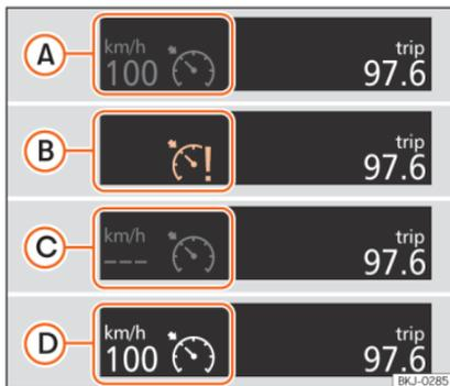
**Abb. 173** Bildschirm des Kombi-Instruments: Zustandsanzeigen der GRA.
