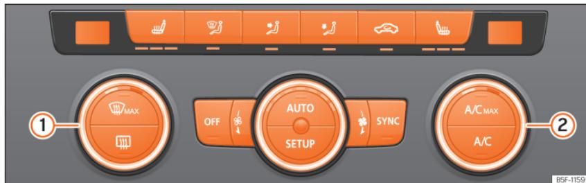
**Abb. 145** In der Mittelkonsole: Bedienelemente der Climatronic.
