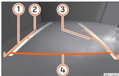
**Abb. 212** Anzeige auf dem Bildschirm des Infotainment-Systems: Orientierungslinien.
