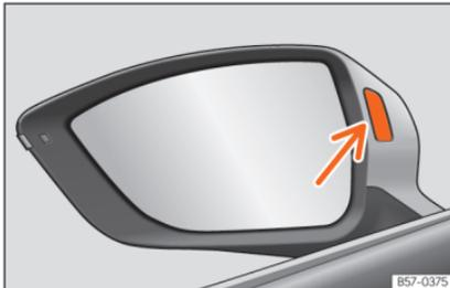
**Abb. 189** Kontrollleuchte des Spurwechselassistenten.
