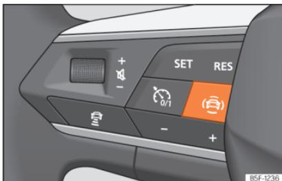
**Abb. 78** Linke Seite des Multifunktionslenkrads: Taste für die Fahrerassistenzsysteme (modellabhängig).
