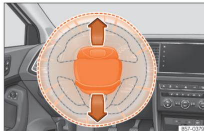
Abb. 14 Einbautort Fahrerairbag: im Lenkrad.
