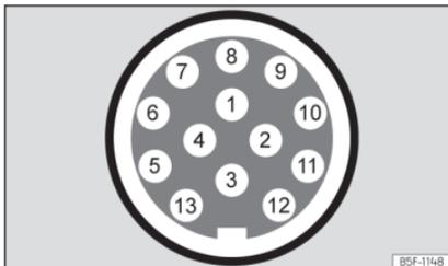
**Abb. 213** Schematische Darstellung: Zuweisung der Steckverbinderstifte für Anhängerstrom.
