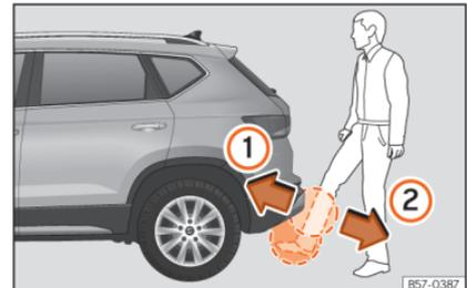
**Abb. 100** Heckklappe mit sensorgesteuerter Öffnung (Easy Open).
