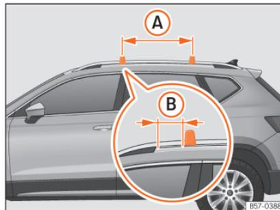
**Abb. 139** Befestigungspunkte der Längsträger für den Dachgepäckträger.
