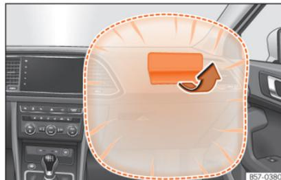
Abb. 15 Beifahrerairbag in der Instrumententafel
