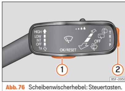
**Abb. 76** Scheibenwischerhebel: Steuertasten.
