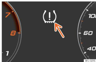
**Abb. 232** Kombi-Instrument: Warnung Reifendruckverlust.
