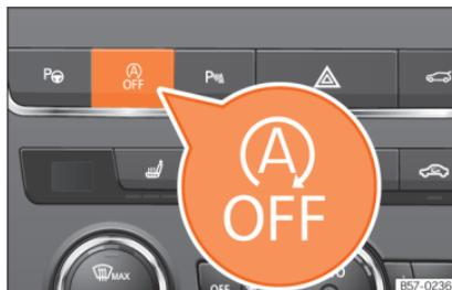
**Abb. 160** Mittelkonsole: Taste des Start-Stopp-Systems.
