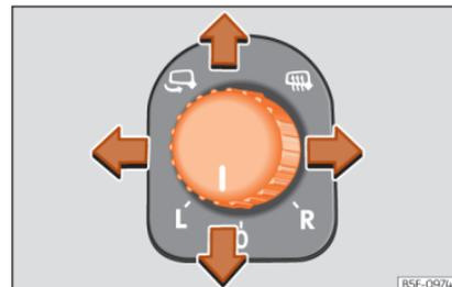
**Abb. 115** Ausschnitt aus der Fahrertür: Drehknot für den Außenspiegel.
