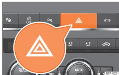
**Abb. 110** Instrumententafel: Schalter für Warnblinkanlage.
