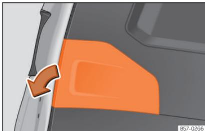
**Abb. 61** Offene Heckklappe: Abdeckung entfernen.
