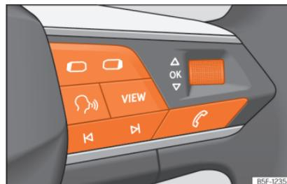
**Abb. 75** Rechte Seite des Multifunktionslenkrads: Bedienelemente für die Menüs und Informationsanzeigen im Kombi-Instrument.
