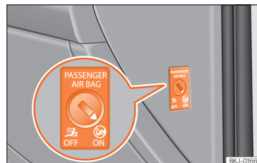
Abb. 29 Schlüsselschalter zum Ein- und Abschalten des Beifahrerairbags.
