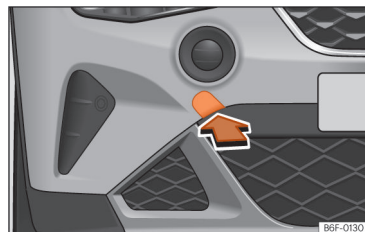
Abb. 162 Auf der rechten Seite des vorderen Stoßfängers: Abdeckung entfernen.
