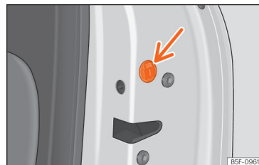
Abb. 55 Notfallsperre der Tür.
