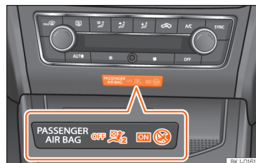
Abb. 30 Instrumententafel-Mittelteil: Kontrollleuchte für abgeschalteten Beifahrer-Frontairbag.
