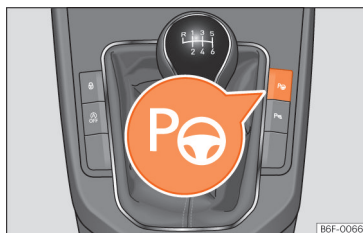
Abb. 122 In der Mittelkonsole: Taste zum Einschalten des Parklenkassistenten.
