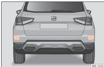
Abb. 97 Bereich hinter dem Fahrzeug: Bereiche der Radarsensoren.
