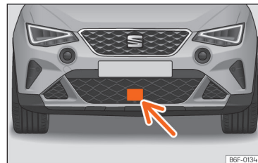
Abb. 94 Im vorderen Stoßfänger: Radarsensor.
