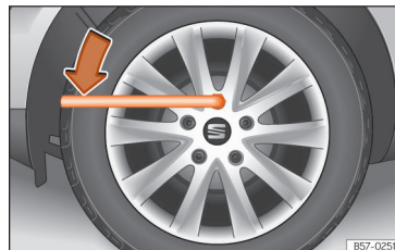
Abb. 194 Radwechsel: Radschrauben lockern
