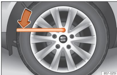
**Abb. 45** Radwechsel: Radschrauben lockern.
