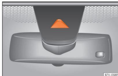
**Abb. 246** An der Windschutzscheibe: Kamerasichtfenster des Spurhalteassistenten.
