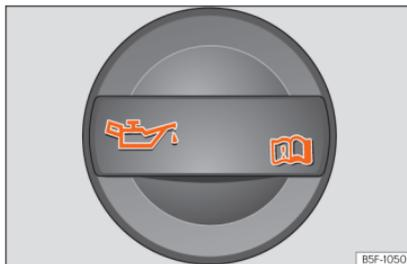
**Abb. 291** Deckel der Motoröl-Einfüllöffnung im Motorraum
