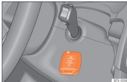
**Abb. 235** Notstart bei Fahrzeugen mit Keyless Access.
