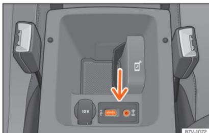
**Abb. 231** Mittelarmlehne vorne: USB/AUX-IN Anschluss.
