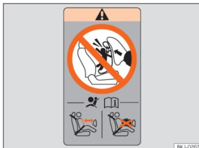
**Abb. 28** Airbagaufkleber: Im hinteren Rahmen der Beifahrertür
