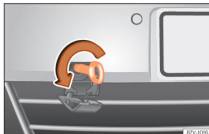
**Abb. 56** Im Stoßfänger vorn rechts: Abschleppöse einschrauben.
