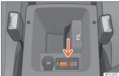
**Abb. 185** Mittelarmlehne vorne: USB/AUX-IN Anschluss.
