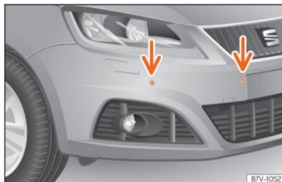
**Abb. 272** Sensoren der Parkdistanzkontrolle vorn im Stoßfänger.
