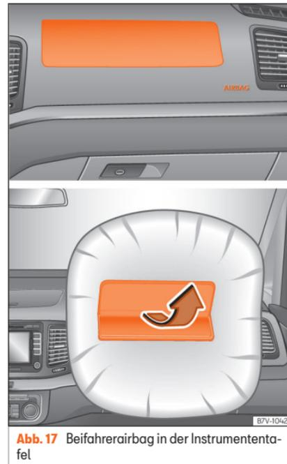
Abb. 17 Beifahrerairbag in der Instrumententafel
