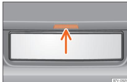
Abb. 101 Heckklappe von außen öffnen.
