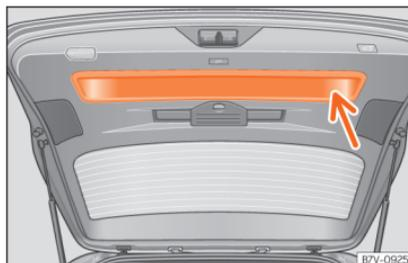
**Abb. 103** Offene Heckklappe: Griffmulde zum Zuziehen.
