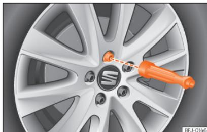
**Abb. 49** Radwechsel: Radschrauben mit dem Schraubendrehergriff herausdrehen.
