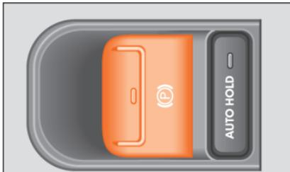
**Abb. 266** In der Mittelkonsole: Taste für elektronische Parkbremse.
