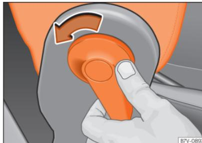
**Abb. 139** Klappbare Beifahrersitzlehne entriegeln.
