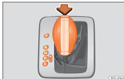
**Abb. 238** Wählhebel des automatischen Getriebes mit Sperrtaste (Pfeil).
