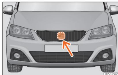
**Abb. 244** Am vorderen Stoßfänger: Radarsensor.
