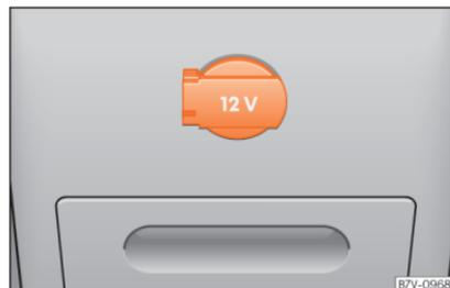
Abb. 171 Mittelkonsole hinten: 12-Volt-Steckdose.
