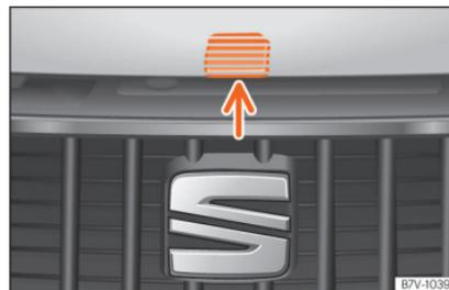
**Abb. 286** Hebel unter der Motorraumklappe.
