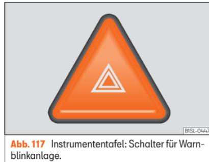
**Abb. 117** Instrumententafel: Schalter für Warnblinkanlage.
