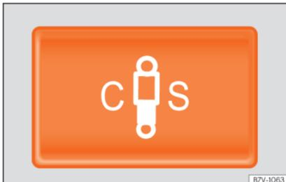
**Abb. 243** In der Mittelkonsole: Taste zum Einstellen der adaptiven Fahrwerksregelung.
