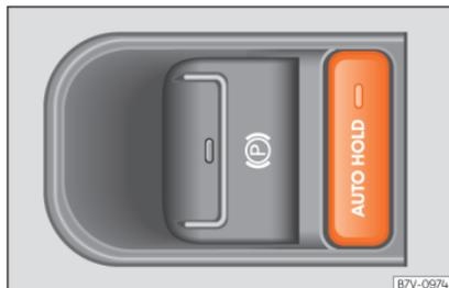
**Abb. 267** Ansicht der Mittelkonsole: Taste für Auto Hold.
