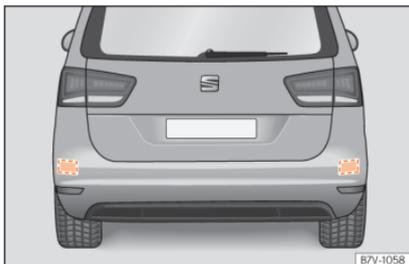
**Abb. 247** Heckansicht des Fahrzeugs: Bereiche der Radarsensoren.
