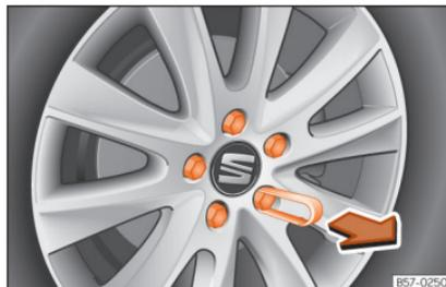
**Abb. 43** Rad: Radschrauben mit Deckel.
