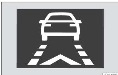
**Abb. 252** Am Bildschirm des Kombi-Instruments: Anzeigen der Vorwarnung.
