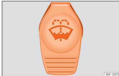
**Abb. 295** Im Motorraum: Deckel des Scheibenwaschbehälters.
