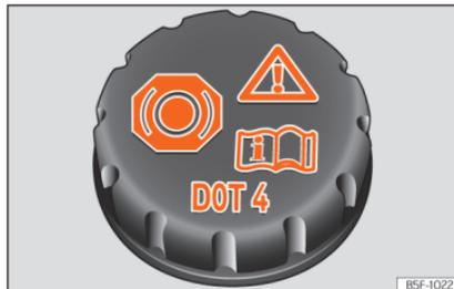
**Abb. 294** Motorraum: Deckel des Bremsflüssigkeitsbehälters.
