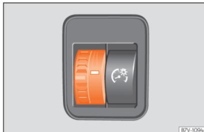
**Abb. 119** Neben dem Lenkrad: Regler für Instrumenten- und Schalterbeleuchtung
