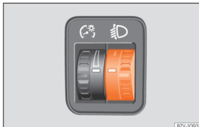
**Abb. 118** Neben dem Lenkrad: Regler für die Leuchtweitenregulierung.
