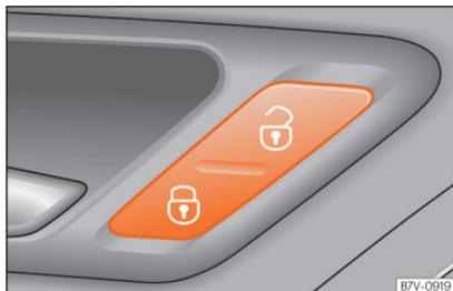
Abb. 90 Fahrertür: Zentralverriegelungstaster.
