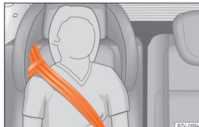
**Abb. 35** Integrierter Kindersitz: Gurtbandverlauf mit Gurtführungsschleufe.
