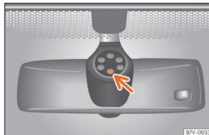
Abb. 122 Sensitive Fläche des Regensensors.
