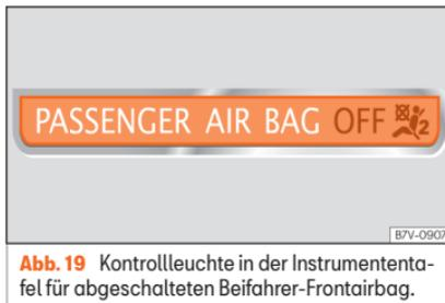
**Abb. 19** Kontrollleuchte in der Instrumententafel für abgeschalteten Beifahrer-Frontairbag.
