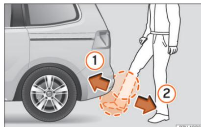
**Abb. 106** Heckklappe mit sensorgesteuerter Öffnung (Easy Open).
