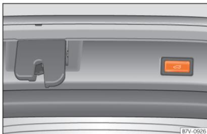
Abb. 104 Taste in der geöffneten Heckklappe.
