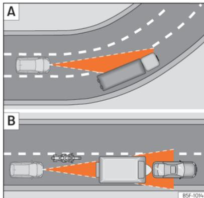
**Abb. 188** **A**) Fahrzeug in einer Kurve. **B**) Vorausfahrender Motorradfahrer außerhalb des Erfassungsbereichs des Radarsensors.
