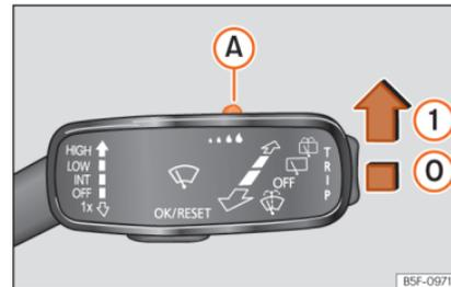
**Abb. 98** Scheibenwischerhebel: Regensensor einstellen **A**.
