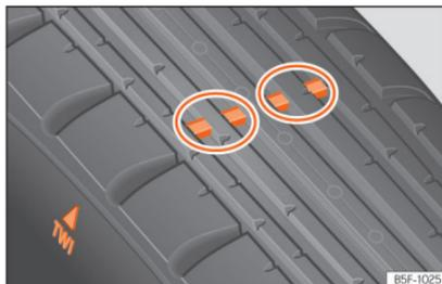
Abb. 251 Reifenprofil: Verschleißanzeiger.
