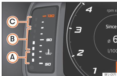
Abb. 61 Frei konfigurierbares Kombiinstrument: Motorkühlmittel-Temperaturanzeige.
