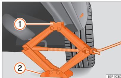
**Abb. 38** Längsholm: Wagenheber ansetzen.
