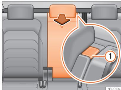
**Abb. 129** Rücksitzelehne: Öffnung der Durchladeeinrichtung.
