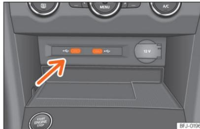
Abb. 159 Mittelkonsole: USB-Eingang.
