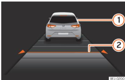
**Abb. 186** Am Bildschirm des Kombi-Instruments: ACC aktiv.
