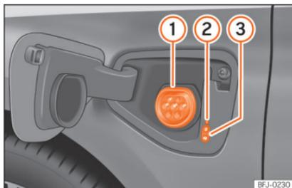
**Abb. 227** Hinter der Batterieladeklappe vorn links: Ladedose
