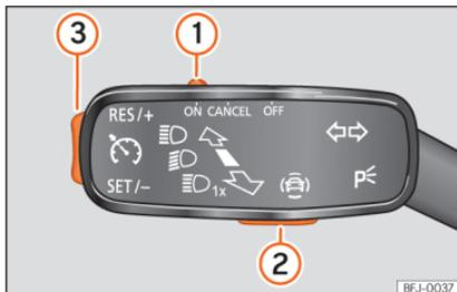
**Abb. 181** Am Blinkerhebel: Tasten zur Bedienung des Geschwindigkeitsbegrenzers.
