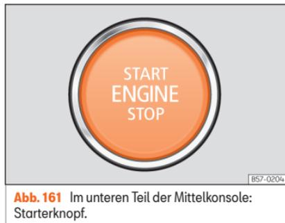
**Abb. 161** Im unteren Teil der Mittelkonsole: Starterknopf.
