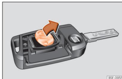
**Abb. 74** Fahrzeugschlüssel: Batterie herausnehmen.
