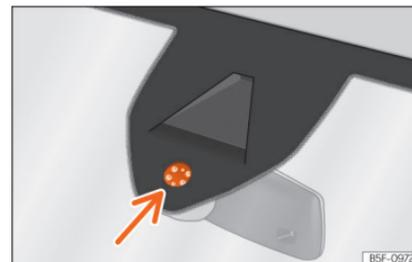
**Abb. 99** Sensitive Fläche des Regensensors.
