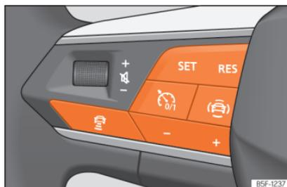
**Abb. 185** Am Multifunktionslenkrad: Tasten zur ACC-Bedienung
