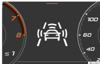
**Abb. 182** Am Bildschirm des Kombi-Instrumentes: Anzeigen der Vorwarnung.
