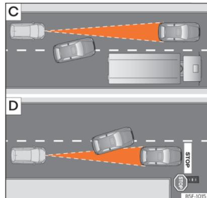
**Abb. 189** **C**) Fahrspurwechsel eines anderen Fahrzeugs. **D**) Abbiegendes und weiteres stehendes Fahrzeug.
