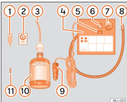
**Abb. 32** Prinzipdarstellung: Bestandteile des Pannensets.
