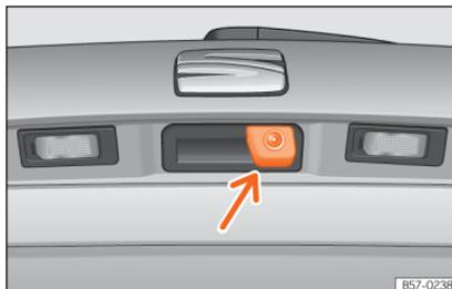
**Abb. 177** Im Griff der Heckklappe: Umgebungsansicht.
