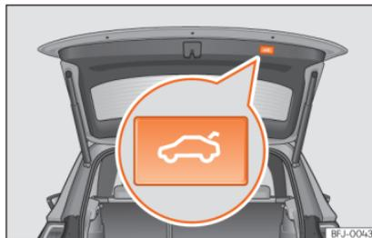
**Abb. 84** Heckklappe: Taste zum Schließen der Heckklappe.
