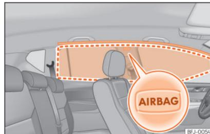
Abb. 22 Einbauort der Kopfairbags
