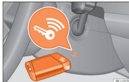
Abb. 162 Rechts an der Lenksäule: Notstart.
