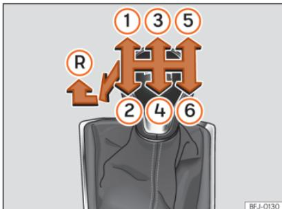
**Abb. 165** Schaltschema des 6-Gang-Schaltgetriebes.
