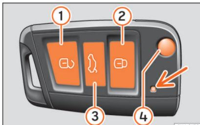
Abb. 71 Tasten im Funkschlüssel.
