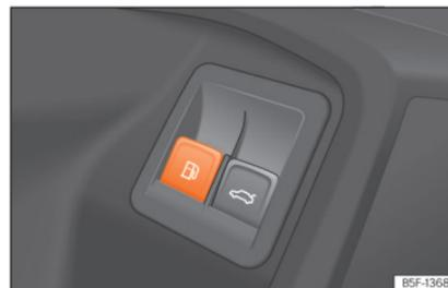
Abb. 234 Fahrertür: Tankklappenentriegelung.
