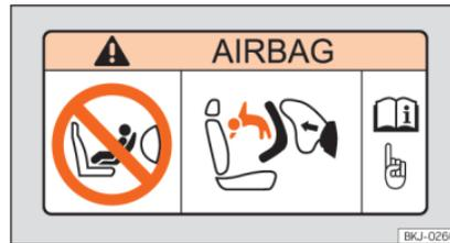
Abb. 24 Airbagaufkleber: an der Sonnenblende auf der Beifahrerseite
