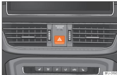
**Abb. 95** Instrumententafel: Schalter für Warnblinkanlage.
