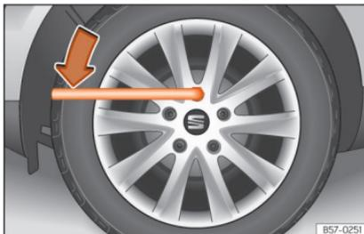
**Abb. 35** Radwechsel: Radschrauben lockern.
