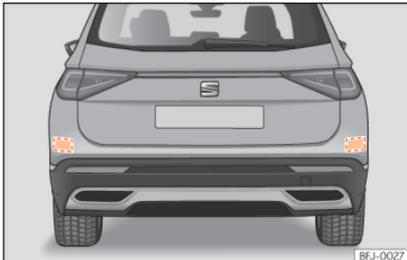
**Abb. 175** Heckansicht des Fahrzeugs: Bereiche der Radarsensoren.
