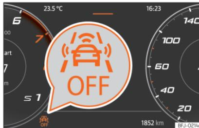
**Abb. 183** Am Bildschirm des Kombi-Instrumentenbretts: Anzeige, dass Front Assist ausgeschaltet ist.
