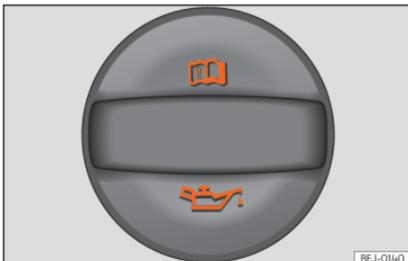
**Abb. 242** Deckel der Motoröl-Einfüllöffnung im Motorraum
