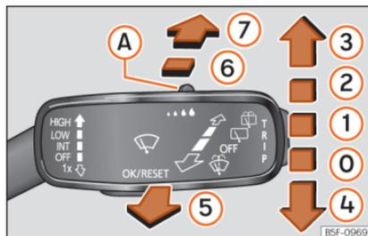
Abb. 97 Bedienung von Windschutz- und Heckscheibenwischer
