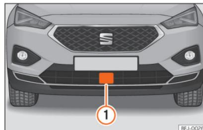
**Abb. 172** Am vorderen Stoßfänger: Radarsensor.
