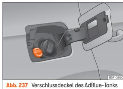
**Abb. 237** Verschlussdeckel des AdBlue-Tanks
