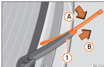
**Abb. 42** Scheibenwischerblatt der Heckscheibe auswechseln.
