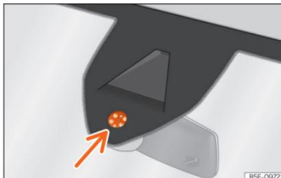
**Abb. 151** Feuchtigkeits- und Temperatursensor der Windschutzscheibe.
