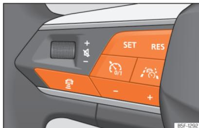
**Abb. 193** Linke Seite des Multifunktionslenkrads: Tasten zur Bedienung von Travel Assist.
