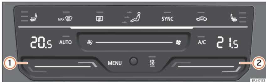
**Abb. 146** In der Mittelkonsole: Bedienelemente der Climatronic.
