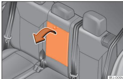
Abb. 117 Herausklappbare Mittelarmlehne hinten.
