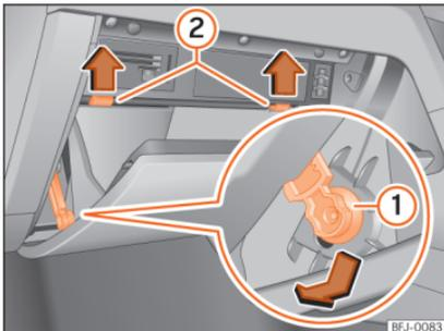
**Abb. 50** Handschuhfach (Rechtslenker): Zugang zum Sicherungskasten.
