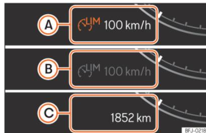
Abb. 180 Am Bildschirm des Kombi-Instruments: Statusanzeigen des Geschwindigkeitsbegrenzers.
