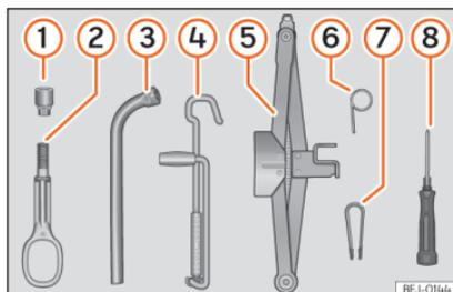
**Abb. 31** Im Gepäckraum unter dem Gepäckraumboden: Bordwerkzeug.
