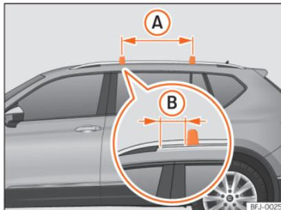
**Abb. 133** Befestigungspunkte der Längsträger für den Dachgepäckträger.
