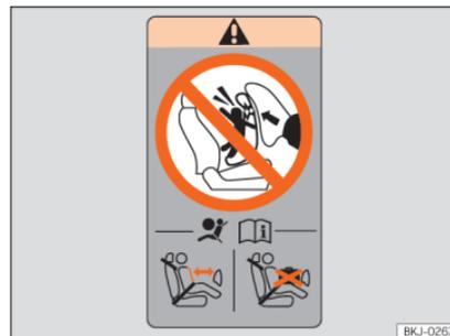
Abb. 25 Airbagaufkleber: Im hinteren Rahmen der Beifahrertür
