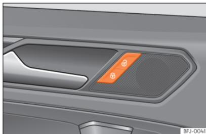
**Abb. 76** Fahrertür: Zentralverriegelungstaster.
