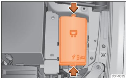
**Abb. 51** Im Motorraum: Abdeckung des Sicherungskastens.
