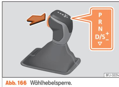
Abb. 166 Wählhebelsperre.
