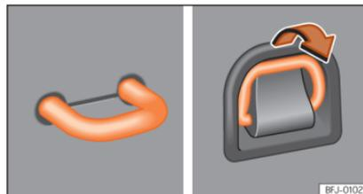
Abb. 126 Im Gepäckraum: feststehende und herausklappbare Verzurrösen.
