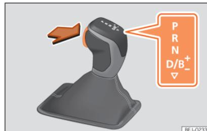
Abb. 167 Wählhebelsperre [Hybridfahrzeuge].
