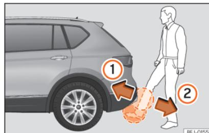
**Abb. 86** Heckklappe mit sensorgesteuerter Öffnung (Easy Open).
