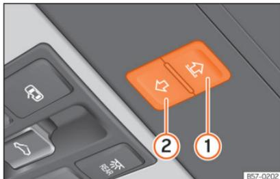
**Abb. 90** Im Dachhimmel: Tasten des Sonnenschutzrollos.
