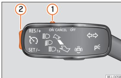
**Abb. 179** Am Blinkerhebel: Bedienelemente zur Bedienung der GRA.
