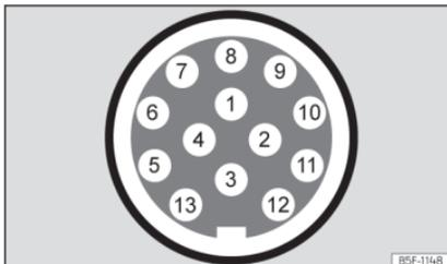
**Abb. 219** Schematische Darstellung: Zuweisung der Steckverbindersteife für Anhängerstrom.
