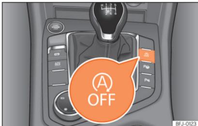
**Abb. 163** Mittelkonsole: Taste des Start-Stopp-Systems.
