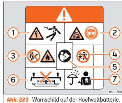
Abb. 223 Warnschild auf der Hochvoltbatterie.
