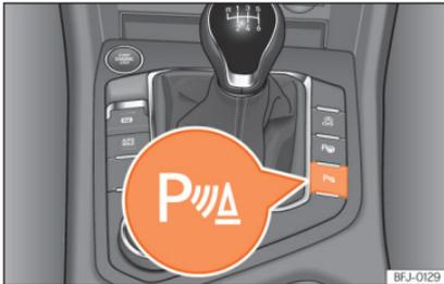
Abb. 208 Mittelkonsole: Taste für Einparkhilfe.
