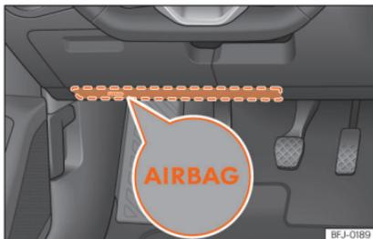
**Abb. 19** Auf der Fahrerseite: Einbauort des Knieairbags.
