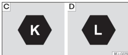
**Abb. 226** Kennzeichnung Gleichstrom [DC] und CCS-Fahrzeugestecker
