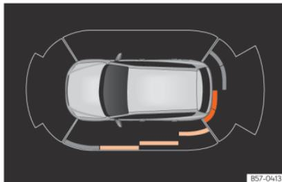
**Abb. 209** Anzeige der Einparkhilfe auf dem Bildschirm des Infotainment-Systems.
