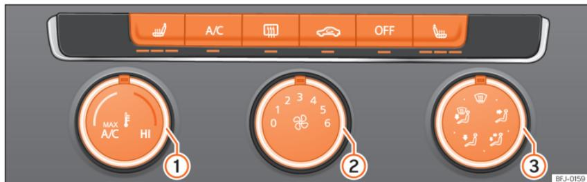
**Abb. 147** In der Mittelkonsole: Bedienungselemente für die Klimaanlage.
