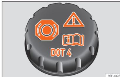
Abb. 246 Motorraum: Deckel des Bremsflüssigkeitsbehälters.
