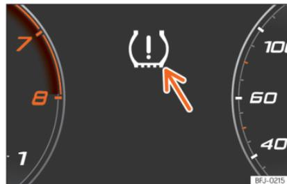
Abb. 253 Kombi-Instrument: Warnung Reifendruckverlust.
