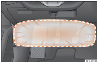
**Abb. 20** Auf der Fahrerseite: Wirkungsbereich des Knieairbags.
