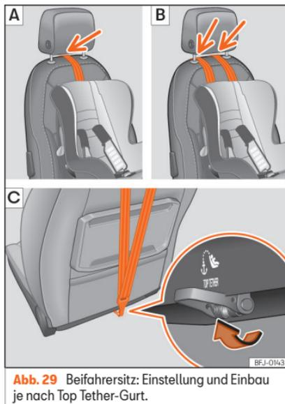
**Abb. 29** Beifahrersitz: Einstellung und Einbau je nach Top Tether-Gurt.
