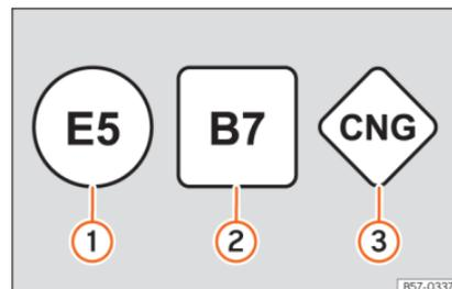
**Abb. 236** Kraftstoffkennzeichnung nach EU-Richtlinie 2014/94/EU
