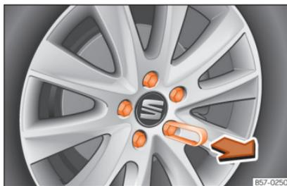
**Abb. 33** Rad: Radschrauben mit Deckel.
