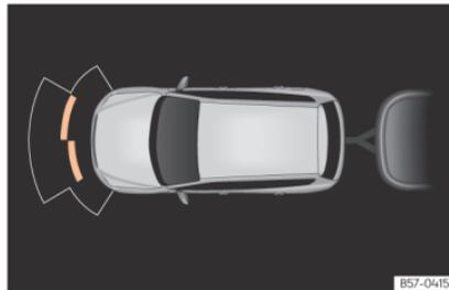
**Abb. 210** Bildschirmanzeige der Einparkhilfe im Anhängerbetrieb.
