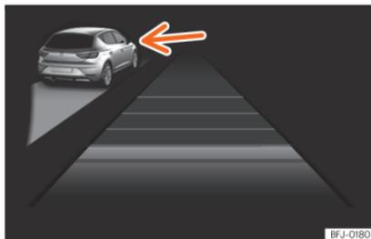
**Abb. 187** Am Bildschirm des Kombi-Instruments: ACC aktiv, Fahrzeug auf der linken Seite erkannt
