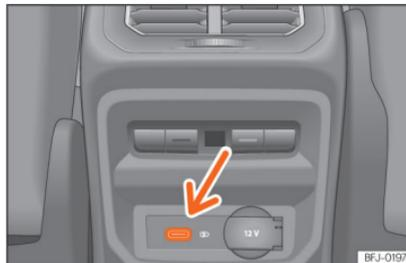
Abb. 160 Mittelkonsole hinten: USB-Anschlüsse mit Steckdosenfunktion.
