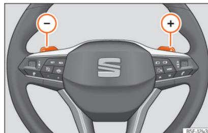
**Abb. 168** Lenkrad: Hebel für Automatikgetriebe.
