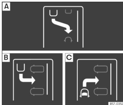
**Abb. 203** Am Bildschirm des Kombi-Instruments: Anzeige der Parkmodi.
