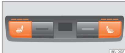
**Abb. 150** In der Mittelkonsole hinten: Bedienelemente für die Sitzheizung der Rücksitze.
