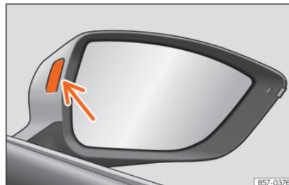
**Abb. 195** Kontrollleuchte des Spurwechselassistenten.
