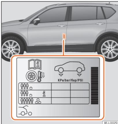
**Abb. 250** Einbauort des Aufklebers für den Reifendruck.
