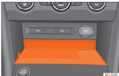
**Abb. 158** In der Mittelkonsole: Aufnahme für die Mobiltelefonkopplung.
