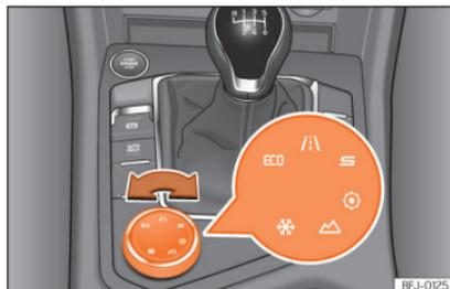
**Abb. 170** Mittelkonsole: Drehknopf (Driving Experience button).
