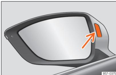
**Abb. 194** Kontrollleuchte des Spurwechselassistenten.
