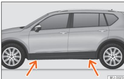
**Abb. 37** Aufnahmepunkte für den Wagenheber.
