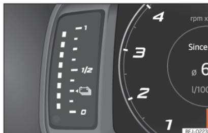
**Abb. 59** Kombi-Instrument: Anzeige des Batterieladestatus.
