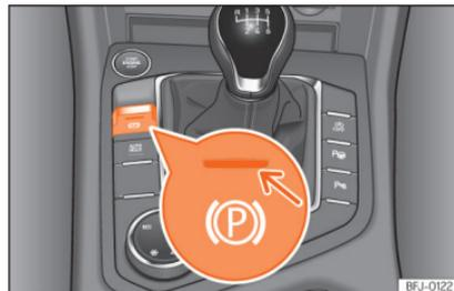
**Abb. 199** Im unteren Teil der Mittelkonsole: Taste für elektronische Parkbremse.
