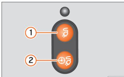
**Abb. 224** Hinter der Batterieladeklappe: Lade-taster
