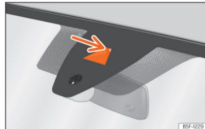
**Abb. 174** An der Windschutzscheibe: Kamerasichtfenster des Spurhalteassistenten.
