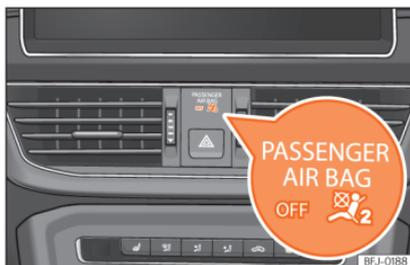
**Abb. 18** Instrumententafel: Kontrollleuchte für Abschaltung des Beifahrerairbags.
