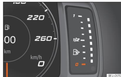
**Abb. 60** Frei konfigurierbares Kombiinstrument: Kraftstoffvorratsanzeige
