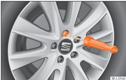
**Abb. 39** Radwechsel: Radschrauben mit dem Schraubendrehergriff herausdrehen.
