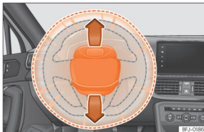
Abb. 15 Einbauort Fahrerairbag: im Lenkrad.
