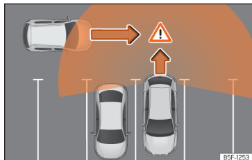
Abb. 123 Schematische Abbildung des Ausparkassistenten: Überwachter Bereich des ausparkenden Fahrzeugs.
