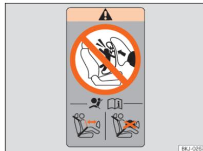
**Abb. 41** Airbag-Label: am hinteren Rahmen der Beifahrertür.
