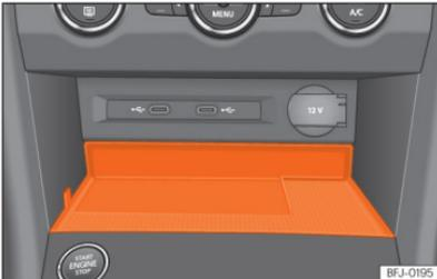
**Abb. 193** In der Mittelkonsole: Aufnahme für die Mobiltelefonkopplung.
