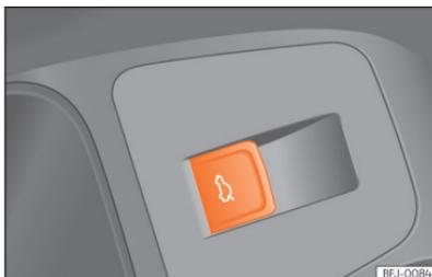
**Abb. 78** In der Fahrertür: Taste zum Öffnen und Schließen der Heckklappe.
