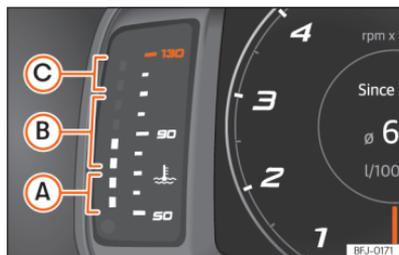
**Abb. 10** Digitales Kombi-Instrument SEAT Digital Cockpit: Motorkühlmitteltemperatur-Anzeige.
