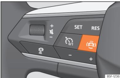
**Abb. 131** Linke Seite des Multifunktionslenkrads: Taste für die Fahrerassistenzsysteme (modellabhängig).
