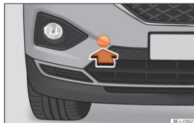
**Abb. 225** Auf der rechten Seite des vorderen Stoßfängers: Abdeckung entfernen.
