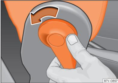
**Abb. 91** Klappbare Beifahrersitzlehne entriegeln.
