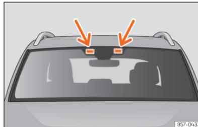
**Abb. 117** Bereiche für das Anbringen elektronischen Zubehörs
