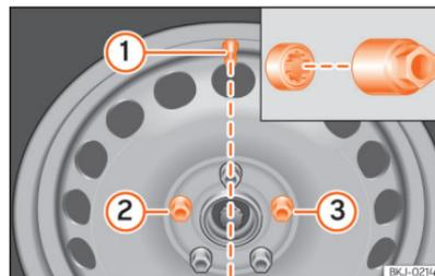
**Abb. 254** Radwechsel: Reifenventil (1) und Einbaort der Anti-Diebstahl-Radschraube (2) oder (3).
