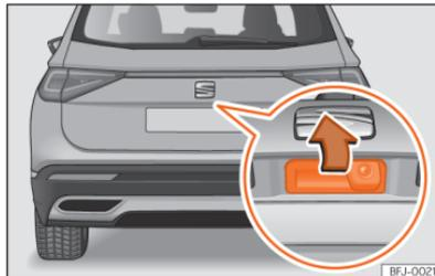
Abb. 76 Heckklappe: Öffnen von außen
