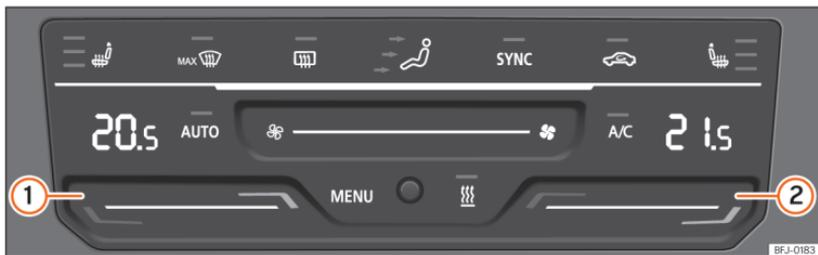
**Abb. 113** In der Mittelkonsole: Bedienelemente der Climatronic.
