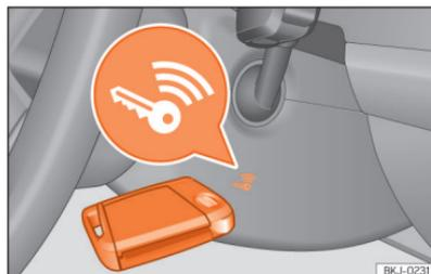
**Abb. 120** Rechts an der Lenksäule: Notstart.
