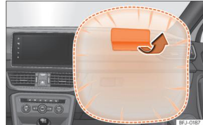
**Abb. 32** Beifahrerairbag in der Instrumententafel
