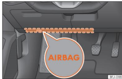
**Abb. 37** Auf der Fahrerseite: Einbauort des Knieairbags.
