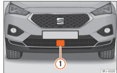
**Abb. 132** Im vorderen Stoßfänger: Radarsensor.
