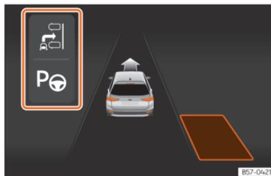
**Abb. 163** Am Bildschirm des Kombi-Instruments: Anzeige des Parklenkassistenten mit eingeschränkter Sicht.
