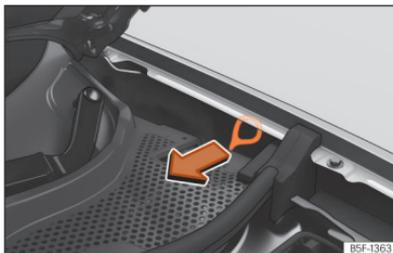
**Abb. 59** Zwischen dem linken Kotflügel und dem Scharnier der Frontklappe: Ziehgriff für manuelle Notentriegelung des Ladesteckers.
