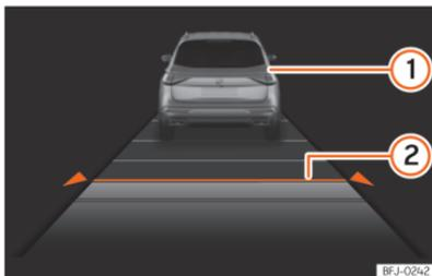
**Abb. 140** Am Bildschirm des Kombi-Instruments: ACC aktiv.
