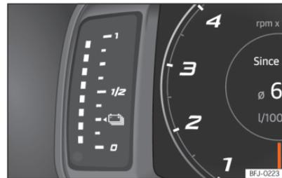
**Abb. 8** Kombi-Instrument: Anzeige des Batterieladezustands.
