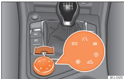
**Abb. 128** Mittelkonsole: Drehknopf (Driving Experience button).
