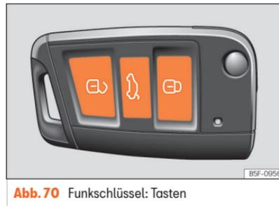
**Abb. 70** Funkschlüssel: Tasten
