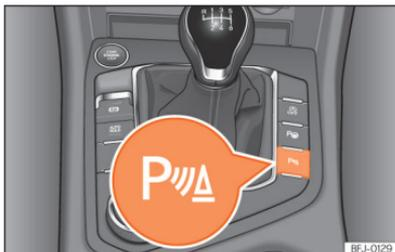
**Abb. 159** Mittelkonsole: Taste für Einparkhilfe (je nach Ausführung).
