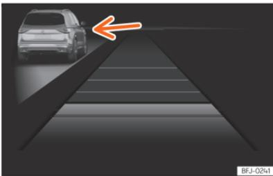
**Abb. 142** Am Bildschirm des Kombi-Instruments: ACC aktiv, Fahrzeug auf der linken Seite erkannt.
