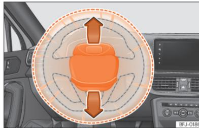
**Abb. 31** Einbauort Fahrerairbag: im Lenkrad.
