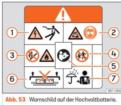
Abb. 53 Warnschild auf der Hochvoltbatterie.
