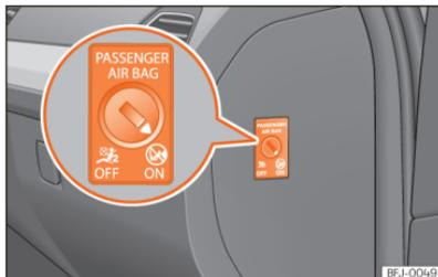
**Abb. 33** Schlüsselschalter zum Ein- und Abschalten des Beifahrerairbags.
