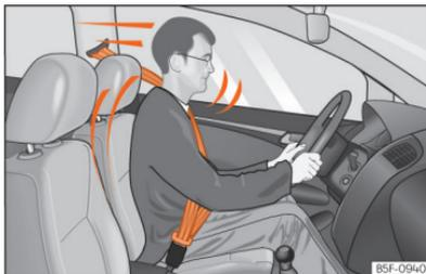
**Abb. 22** Richtig angegurtete Fahrer werden bei einem plötzlichen Bremsmanöver nicht nach vorne geschleudert.
