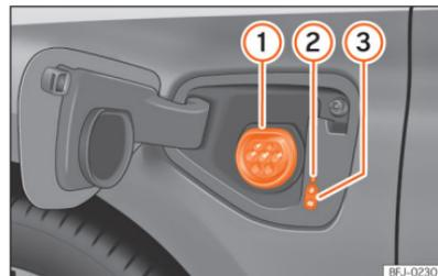
**Abb. 56** Hinter der Batterie-Ladeklappe vorn links: Ladedose.
