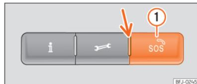
**Abb. 51** In der Dachkonsole: Schalter für Sprachdienste
