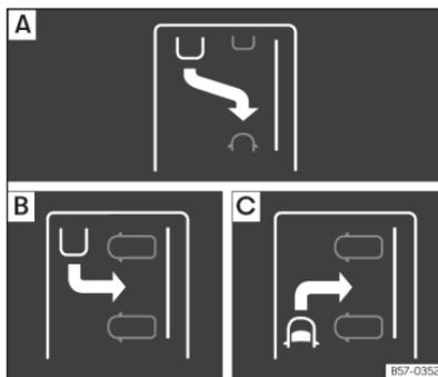
**Abb. 164** Im Bildschirm des Kombi-Instruments: Anzeige der Parkmodi.
