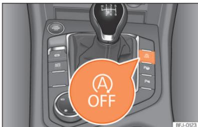
**Abb. 122** Mittelkonsole: Systemtaste Start-Stopp.
