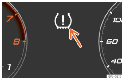
**Abb. 258** Kombi-Instrument: Warnung Reifendruckverlust.
