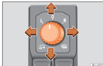
Abb. 111 Ausschnitt der Fahrertür: Außenspiegelbedienung.
