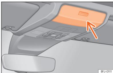
**Abb. 181** In der Dachkonsole: Brillenfach.
