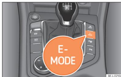
Abb. 121 Mittelkonsole: E-MODE-Taste.
