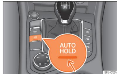
**Abb. 156** Im unteren Bereich der Mittelkonsole: Funktionstaste Auto Hold.
