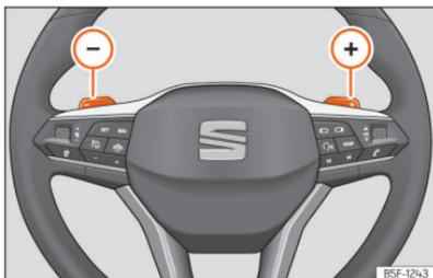
**Abb. 126** Lenkrad: die Hebel für Automatikgetriebe.
