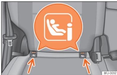
**Abb. 42** Rücksitz: Einbauort der Halteösen ISOFIX oder i-Size.
