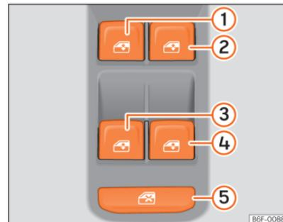
**Abb. 81** Ausschnitt der Fahrerür: Tasten zum Bedienen der elektrischen Fensterheber
