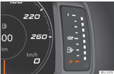
**Abb. 7** Kombi-Instrument SEAT Digital Cockpit: Kraftstoffvorratsanzeige.
