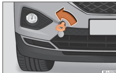
**Abb. 226** Vorderer Stoßfänger rechts: Eingeschraubte Abschleppöse
