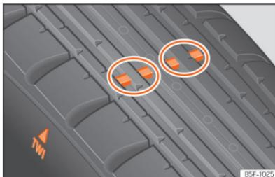
**Abb. 247** Reifenprofil: Verschleißanzeiger.
