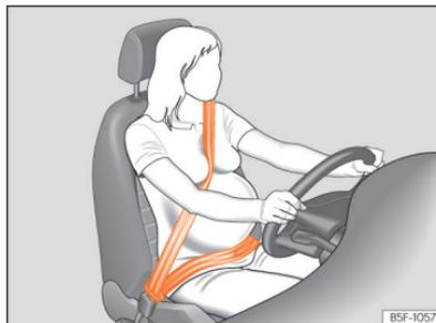
**Abb. 29** Gurtbandverlauf bei schwangeren Frauen.
