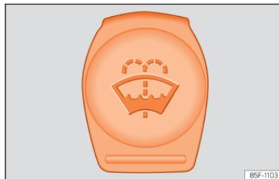
**Abb. 239** Im Motorraum: Blauer Deckel des Scheibenwaschbehälters.
