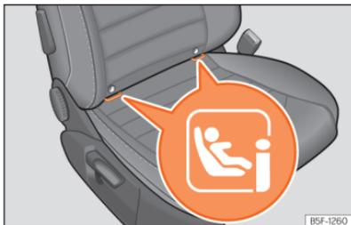
**Abb. 43** Beifahrersitz: Einbauort der Halteösen i-Size.
