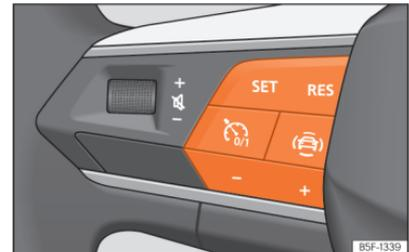
**Abb. 138** Am Multifunktionslenkrad: Tasten zur Bedienung der Geschwindigkeitsregelanlage.
