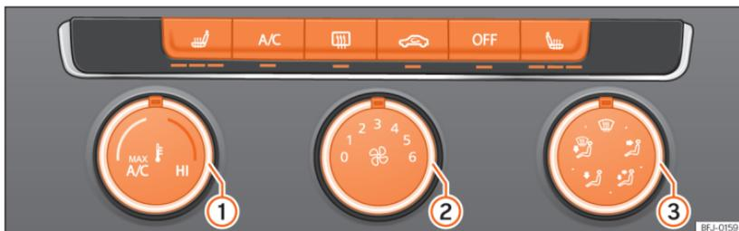
**Abb. 114** In der Mittelkonsole: Bedienelemente der manuellen Klimaanlage.
