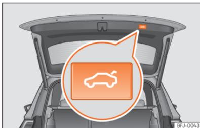
**Abb. 77** Heckklappe: Taste zum Schließen der Heckklappe.
