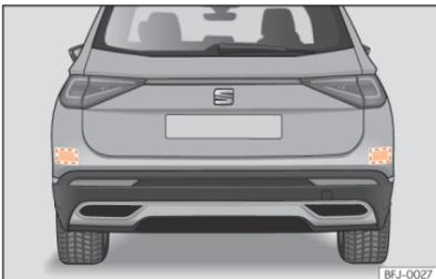
**Abb. 135** Bereich hinter dem Fahrzeug: Bereiche der Radarsensoren.
