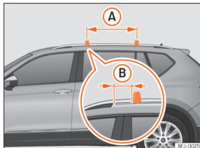
**Abb. 209** Befestigungspunkte der Längsträger für den Dachgepäckträger
