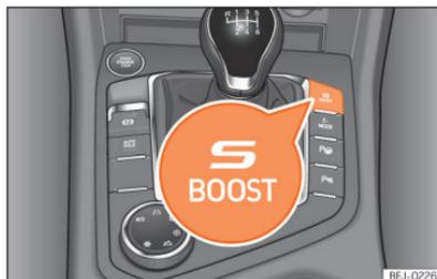
**Abb. 129** Mittelkonsole: Taste S-BOOST
