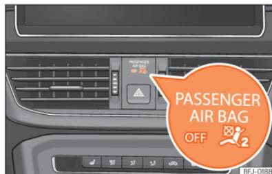
**Abb. 34** Instrumententafel: Kontrollleuchte für abgeschalteten Beifahrerairbag.
