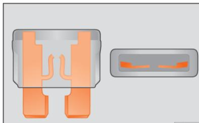
**Abb. 232** Darstellung einer durchgebrannten Sicherung.
