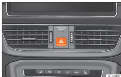
**Abb. 50** Instrumententafel: Schalter für die Warnblinkanlage
