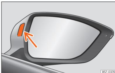
**Abb. 152** Kontrollleuchte des Spurwechselassistenten.
