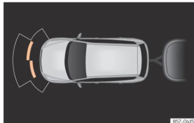
**Abb. 158** Bildschirmanzeige der Einparkhilfe im Anhängerbetrieb.
