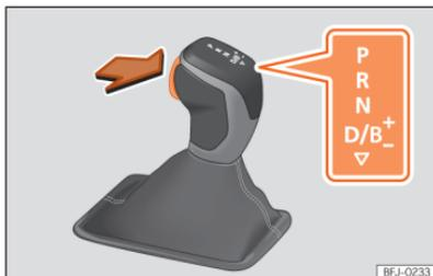
Abb. 125 Wählhebelsperre (Hybridfahrzeuge).
