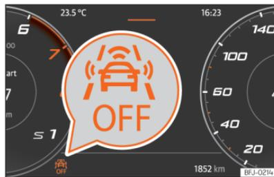
**Abb. 147** Auf dem Display des Kombi-Instruments: Anzeige, dass Front Assist ausgeschaltet ist.
