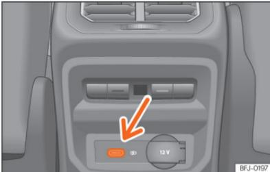
**Abb. 186** Mittelkonsole hinten: USB-Anschlüsse mit Steckdosenfunktion.
