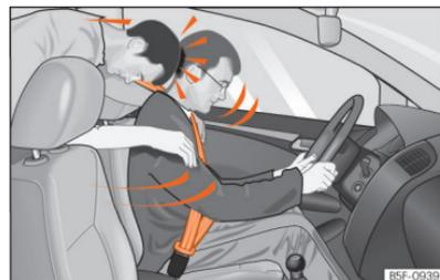
**Abb. 25** Der nicht angegurte Mitfahrer auf dem Rücksitz wird nach vorn auf den angegurten Fahrer geschleudert.
