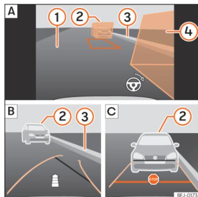
**Abb. 169** Anzeige am Bildschirm des Infotainment-Systems: Rückfahrassistent, Modus 2.
