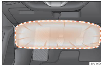
**Abb. 38** Auf der Fahrerseite: Wirkungsbereich des Knieairbags.
