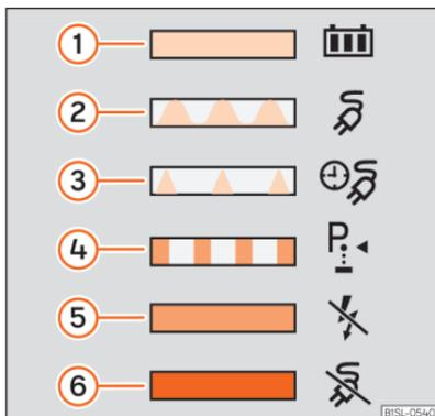
**Abb. 58** Auf der Innenseite der Batterieladeklappe: Aufkleber mit Informationen zur Ladevorgangsanzeige.
