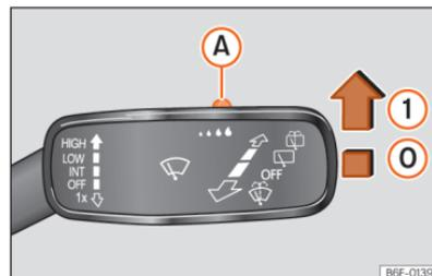
**Abb. 109** Scheibenwischerhebel: Regensensor (A) einstellen.
