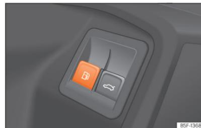
**Abb. 216** Fahrertür: Tankklappenentriegelung.
