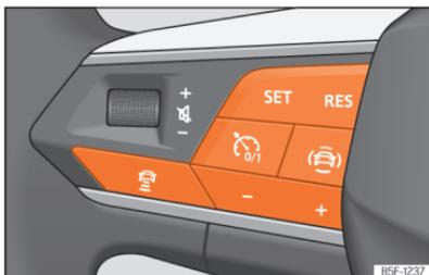
**Abb. 141** Am Multifunktionslenkrad: Tasten zur ACC-Bedienung.
