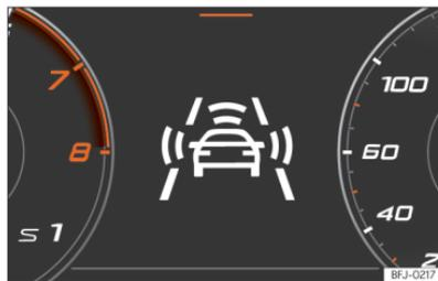
**Abb. 145** Im Display des Kombi-Instruments: Vorwarnhinweise.
