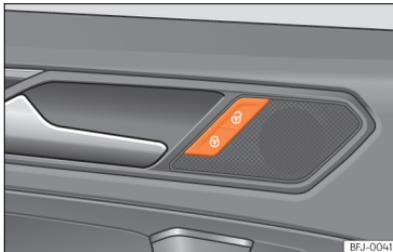
**Abb. 71** In der Fahrtür: Zentralverriegelungstaster.
