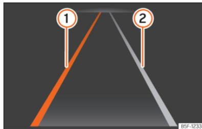
**Abb. 148** Im Display des Kombi-Instruments: Anzeigen des Spurhalteassistenten.
