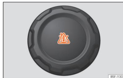
Abb. 237 Frontraum: Verschlussdeckel des Kühlmittelausgleichsbehälters.
