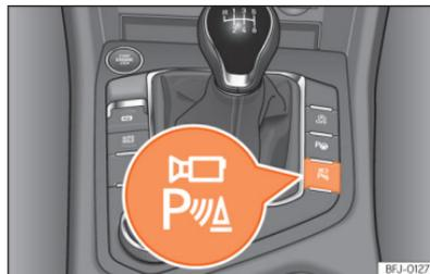
**Abb. 171** Mittelkonsole: Taste zum manuellen Aktivieren und Deaktivieren der Rundumsicht in Verbindung mit dem Parklenkassistent.
