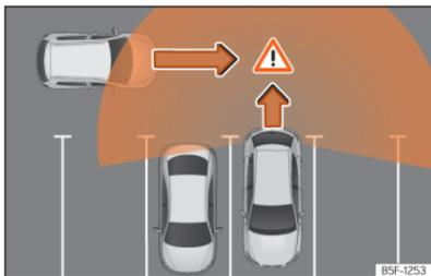
**Abb. 175** Schematische Abbildung des Ausparkassistenten: Überwacher Bereich des ausparkenden Fahrzeugs.
