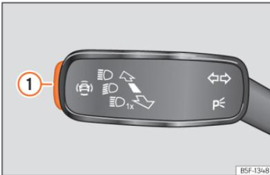
**Abb. 130** Am Blinker- und Fernlichthebel: Taste für die Fahrerassistenzsysteme (modellabhängig).
