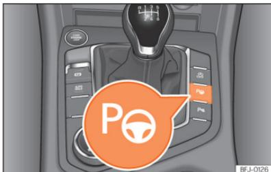
**Abb. 162** In der Mittelkonsole: Taste zum Einschalten des Parklenkassistenten.
