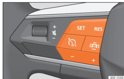
**Abb. 139** Am Multifunktionslenkrad: Tasten zur Bedienung des Geschwindigkeitsbegrenzers.
