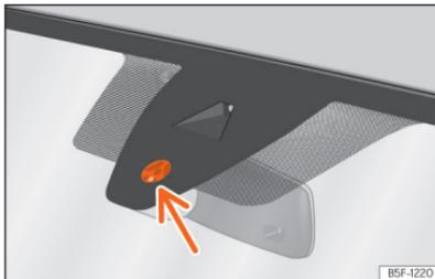
**Abb. 110** Sensitive Fläche des Regensensors.
