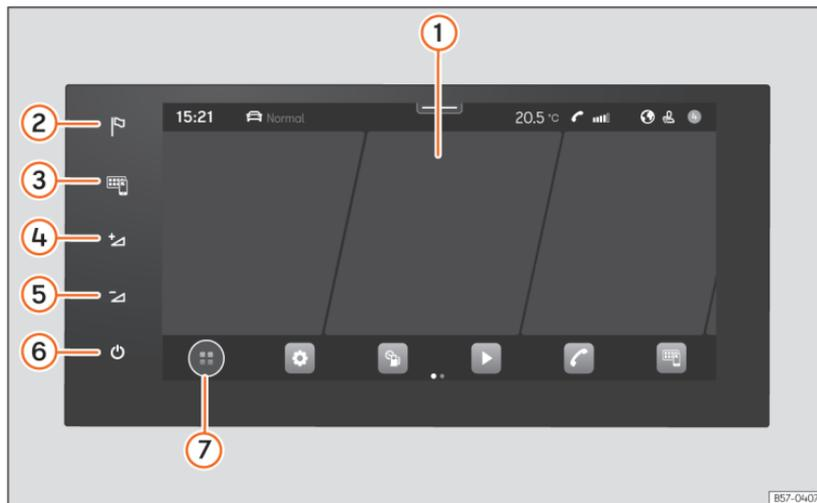
Abb. 187 Übersicht: Schalteinheit.
