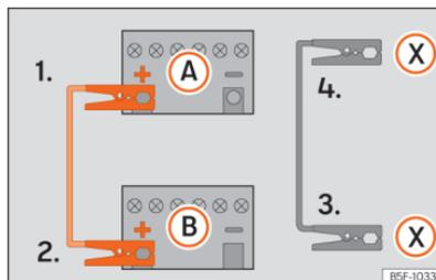
**Abb. 224** Anschlusschema für Fahrzeuge mit Start-Stopp-System.
