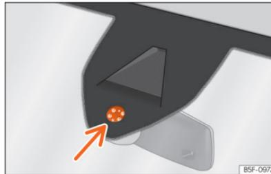
**Abb. 116** Feuchtigkeits- und Temperatursensor der Windschutzscheibe.
