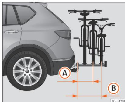
**Abb. 213** Schematische Darstellung des maximalen Überstands der Ladung in einem Fahrradträger für zwei oder drei Fahrräder.
