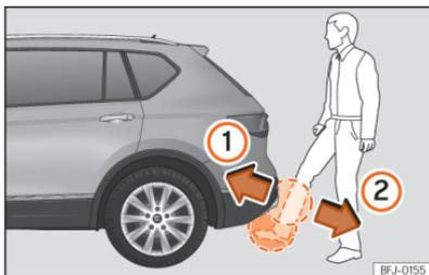
**Abb. 79** Heckklappe mit sensorgesteuerter Öffnung (Easy Open).
