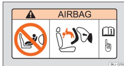
**Abb. 40** Airbag-Label: an der Sonnenblende Beifahrerseite.
