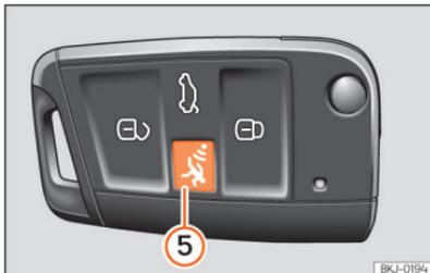
Abb. 65 Fahrzeugschlüssel mit Alarmtaste.
