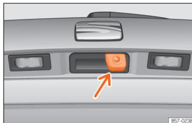
**Abb. 137** Im Griff der Heckklappe: Umfeldkamera.
