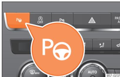
**Abb. 282** Im oberen Teil der Mittelkonsole: Taste zum Einschalten des Parklenkassistenten.
