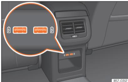
**Abb. 235** Mittelkonsole hinten: USB-Anschlüsse.
