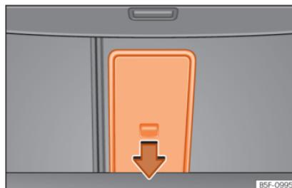
Abb. 143 Im Gepäckraum: Öffnung der Durchladeeinrichtung.
