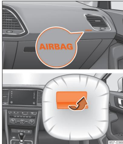
**Abb. 16** Beifahrerairbag in der Instrumententafel
