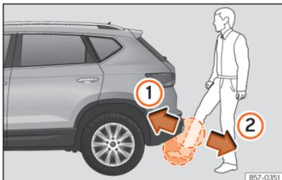
**Abb. 103** Heckklappe mit sensorgesteuerter Öffnung (Easy Open).
