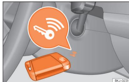
Abb. 240 Rechts an der Lenksäule: Notstart.
