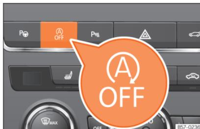
**Abb. 241** Mittelkonsole: Taste des Start-Stopp-Systems.
