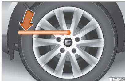
**Abb. 38** Radwechsel: Radschrauben lockern.
