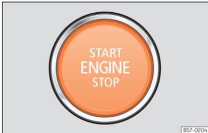
**Abb. 239** Im unteren Teil der Mittelkonsole: Starterknopf.
