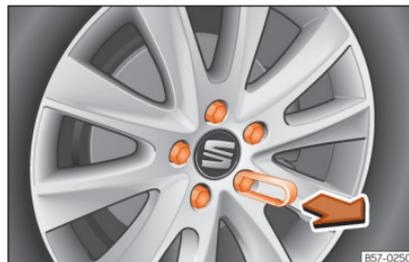
**Abb. 36** Rad: Radschrauben mit Deckel.
