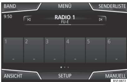
**Abb. 182** Anzeige der Speichertasten im DAB-Modus.
