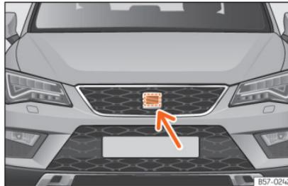
**Abb. 257** Im Frontbereich hinter dem SEAT-Emblem: Radarsensor.
