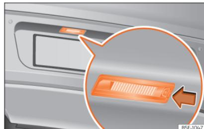
**Abb. 65** Im Stoßfänger hinten: Kennzeichenleuchte.
