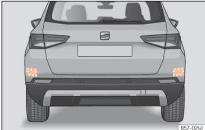
**Abb. 275** Heckansicht des Fahrzeugs: Bereiche der Radarsensoren.
