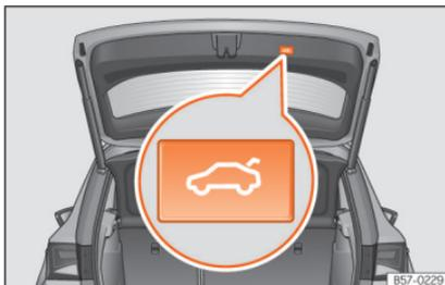
**Abb. 101** Heckklappe: Taste zum Schließen der Heckklappe.
