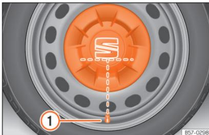
**Abb. 35** Korrekte Anbringung der Radvollblende für Stahlfelgen.
