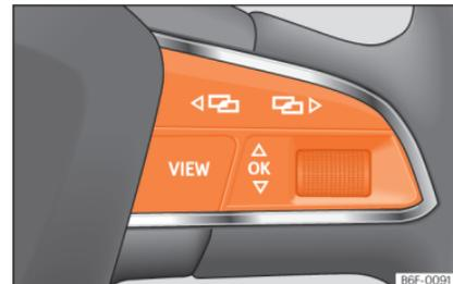
**Abb. 80** Rechte Seite des Multifunktionslenkrads: Bedienelemente für die Menüs und Informationsanzeigen im Kombi-Instrument.
