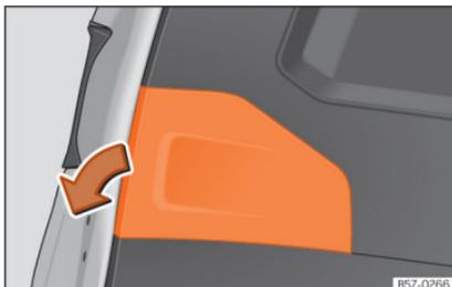
**Abb. 63** Offene Heckklappe: Abdeckung entfernen.
