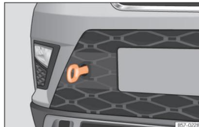
**Abb. 48** Auf der rechten Seite des vorderen Stoßfängers: eingeschraubte Abschleppöse.
