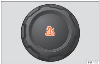
**Abb. 314** Motorraum: Deckel des Motorkühlmittelausgleichsbehälters.
