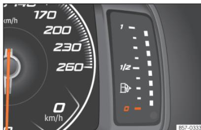
**Abb. 76** Frei konfigurierbares Kombiinstrument: Kraftstoffvorratsanzeige
