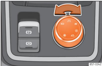
**Abb. 249** Mittelkonsole: Drehknopf (Driving Experience button).
