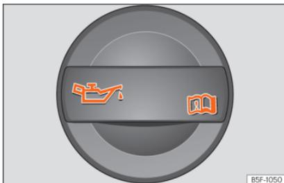
**Abb. 312** Deckel der Motoröl-Einfüllöffnung im Motorraum
