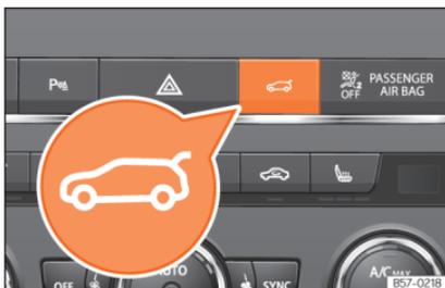
**Abb. 102** Mittelkonsole: Taste zum Öffnen und Schließen der Heckklappe.
