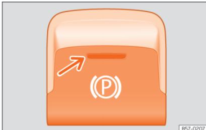
**Abb. 279** Im unteren Teil der Mittelkonsole: Taste für elektronische Parkbremse.
