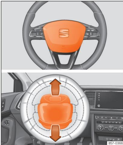
**Abb. 15** Einbauort Fahrerairbag: im Lenkrad.
