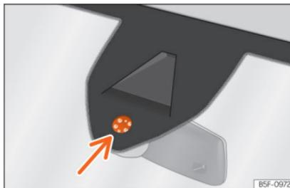
Abb. 156 Feuchtigkeits- und Temperatursensor der Windschutzscheibe.
