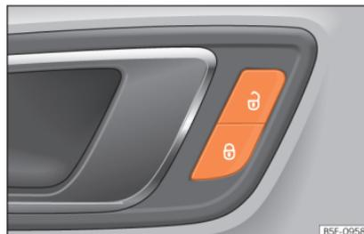
**Abb. 92** Fahrtür: Zentralverriegelungstaster.
