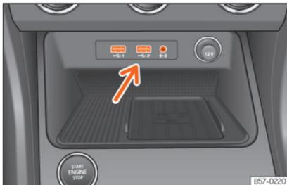
**Abb. 234** Mittelkonsole: USB/AUX-IN Anschluss.
