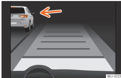
**Abb. 266** Am Bildschirm des Kombi-Instruments: ACC aktiv, Fahrzeug auf der linken Seite erkannt
