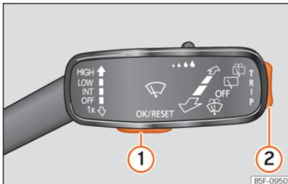
**Abb. 79** Scheibenwischerhebel: Steuertasten.
