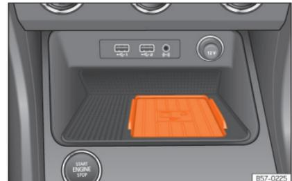
**Abb. 237** In der Mittelkonsole: Aufnahme für die Mobiltelefonkopplung.
