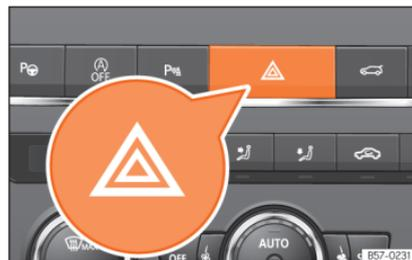
**Abb. 115** Instrumententafel: Schalter für Warnblinkanlage.
