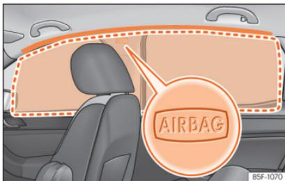
Abb. 23 Einbauort der Kopfairbags
