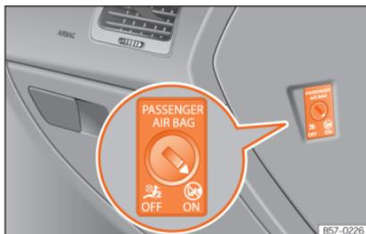
**Abb. 17** Schlüsselschalter zum Ein- und Abschalten des Beifahrerairbags.
