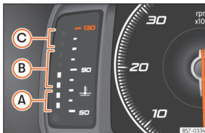
Abb. 78 Frei konfigurierbares Kombiinstrument: Motor Kühlmittel-Temperaturanzeige.
