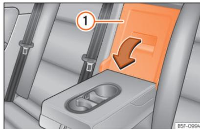
Abb. 142 An der Rücksitzlehne: Öffnung der Durchladeeinrichtung.
