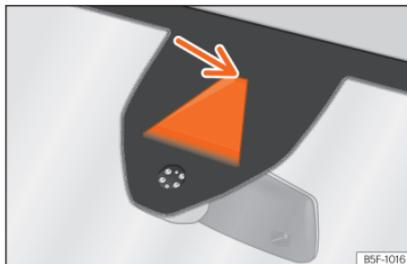
**Abb. 269** An der Windschutzscheibe: Kamera-sichtfenster des Spurhalteassistenten.
