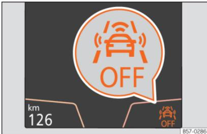
**Abb. 258** Am Bildschirm des Kombi-Instruments: Anzeige, dass Front Assist ausgeschaltet ist.
