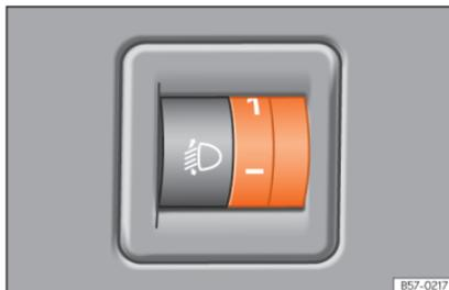
**Abb. 116** Neben dem Lenkrad: Regler für die Leuchtweitenregulierung.
