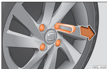
Abb. 53 Abdeckkappen von den Radschrauben abziehen.
