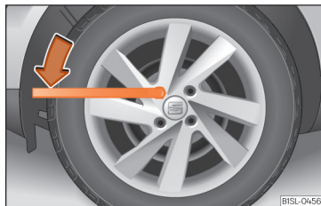
Abb. 54 Radwechsel: Radschrauben lockern.
