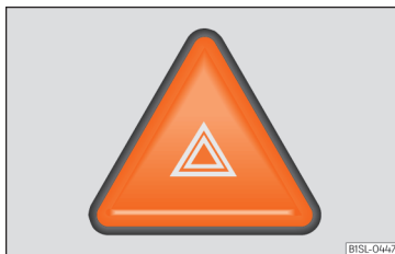
Abb. 32 Instrumententafel: Schalter für die Warnblinkanlage
