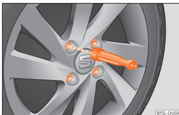
Abb. 58 Radwechsel: Radschrauben mit dem Schraubendrehergriff abschrauben.
