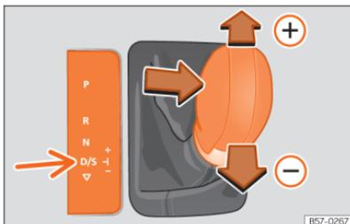
**Abb. 101** Hebel in Tiptronic-Stellung.
