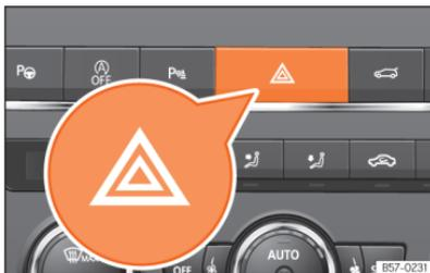
**Abb. 44** Instrumententafel: Schalter für die Warnblinkanlage
