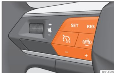
**Abb. 114** Am Multifunktionslenkrad: Tasten zur Bedienung des Geschwindigkeitsbegrenzers.
