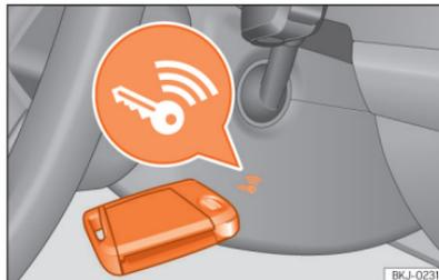
Abb. 97 Rechts an der Lenksäule: Notstart.
