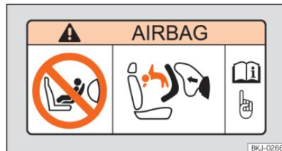
**Abb. 37** Airbag-Label: an der Sonnenblende Beifahrerseite.
