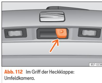
**Abb. 112** Im Griff der Heckklappe: Umfeldkamera.
