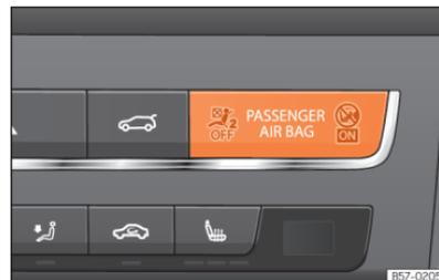
**Abb. 30** Instrumententafel: Kontrollleuchte für abgeschalteten Beifahrerairbag.
