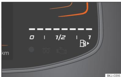
**Abb. 5** Kombi-Instrument Basic: Kraftstoffvorratsanzeige.
