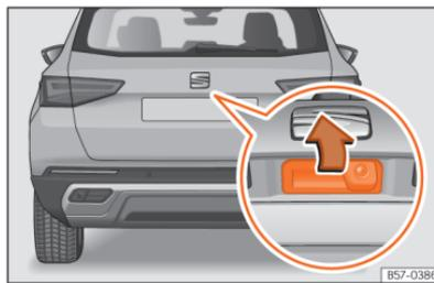
**Abb. 59** Heckklappe: Öffnen von außen
