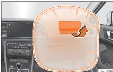
**Abb. 28** Beifahrerairbag in der Instrumententafel
