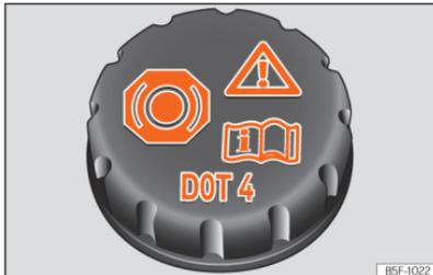
**Abb. 204** Motorraum: Deckel des Bremsflüssigkeitsbehälters
