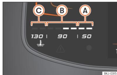
**Abb. 7** Digitales Kombi-Instrument Basic: Motorkühlmitteltemperatur-Anzeige.
