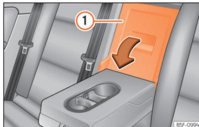
Abb. 175 An der Rücksitzlehne: Öffnung der Durchladeeinrichtung.
