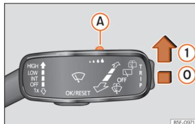
Abb. 87 Scheibenwischerhebel: Regensensor (A) einstellen.
