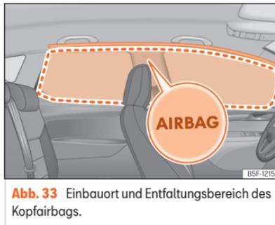
**Abb. 33** Einbauort und Entfaltungsbereich des Kopfairbags.
