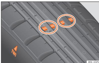
Abb. 212 Reifenprofil: Verschleißanzeiger.
