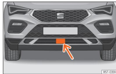
**Abb. 107** Im vorderen Stoßfänger: Radarsensor.
