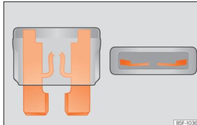
**Abb. 199** Darstellung einer durchgebrannten Sicherung.
