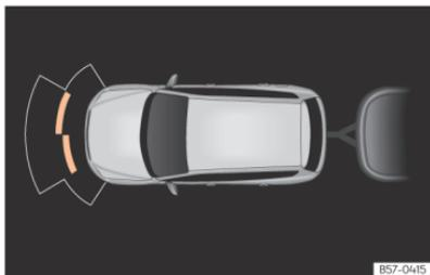
**Abb. 133** Bildschirmanzeige der Einparkhilfe im Anhängerbetrieb.
