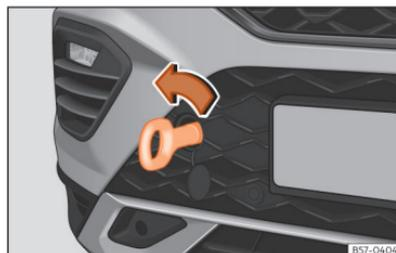
**Abb. 193** Vorderer Stoßfänger rechts: Eingeschraubte Abschleppöse
