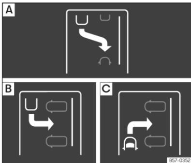
**Abb. 139** Im Bildschirm des Kombi-Instruments: Anzeige der Parkmodi.
