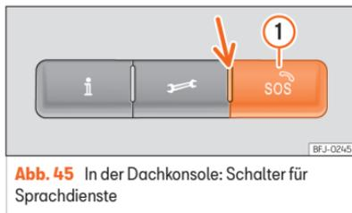
**Abb. 45** In der Dachkonsole: Schalter für Sprachdienste
