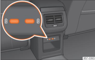
**Abb. 156** Mittelkonsole hinten: USB-Anschlüsse mit Steckdosenfunktion.
