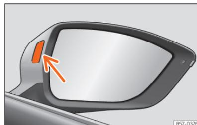
**Abb. 127** Kontrollleuchte des Spurwechselassistenten.
