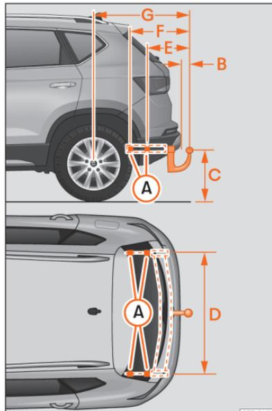
**Abb. 182** Maße und Befestigungspunkte für den nachträglichen Einbau einer Anhängervorrichtung
