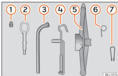
**Abb. 186** Im Gepäckraum unter dem Gepäckraumboden: Bordwerkzeug.
