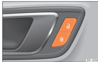
**Abb. 54** In der Fahrertür: Zentralverriegelungstaster.
