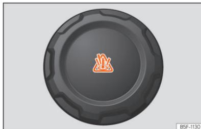
**Abb. 203** Frontraum: Verschlussdeckel des Kühlmittelausgleichsbehälters.
