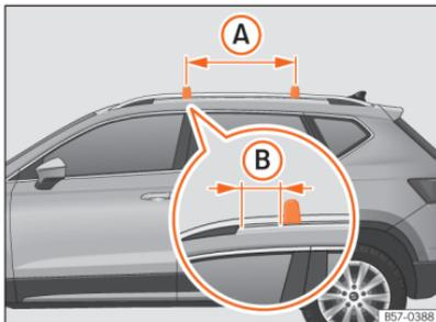
Abb. 177 Befestigungspunkte der Längsträger für den Dachgepäckträger
