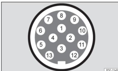
**Abb. 178** Schematische Darstellung: Zuweisung der Steckverbinderstifte für Anhängerstrom.
