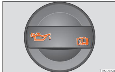
Abb. 209 Deckel der Motoröl-Einfüllöffnung im Motorraum.
