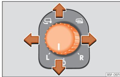
**Abb. 89** Ausschnitt der Fahrertür: Außenspiegelbedienung.
