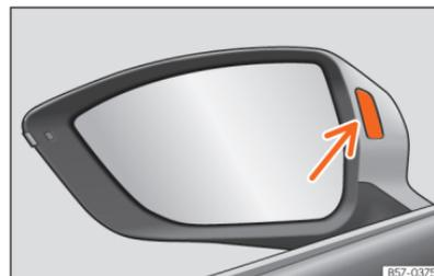
**Abb. 126** Kontrollleuchte des Spurwechselassistenten.
