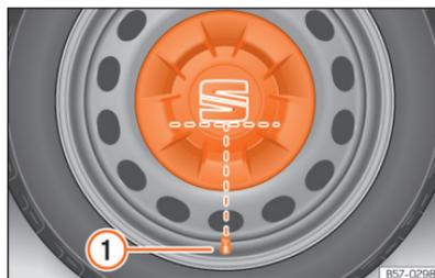
**Abb. 216** Korrekte Anbringung der Radvollblende für Stahlfelgen.
