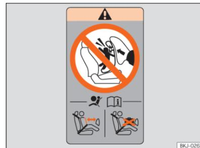
**Abb. 38** Airbag-Label: am hinteren Rahmen der Beifahrertür.
