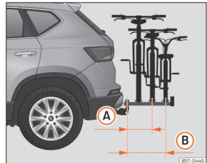
**Abb. 181** Schematische Darstellung des maximalen Überstands der Ladung in einem Fahrradträger für zwei oder drei Fahrräder.
