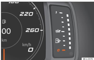
**Abb. 6** Kombi-Instrument SEAT Digital Cockpit: Kraftstoffvorratsanzeige.
