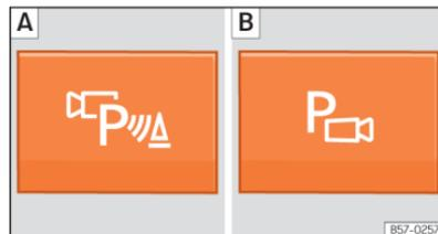
**Abb. 134** Mittelkonsole: Taste für Einparkhilfe (je nach Ausführung).
