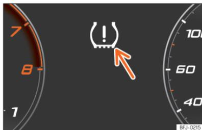
Abb. 223 Kombi-Instrument: Warnung Reifendruckverlust.
