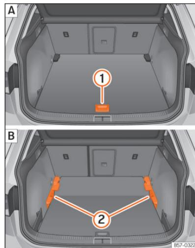
**Abb. 168** Variabler Gepäckraumboden: **A** Hochstellung; **B** Tiefstellung.
