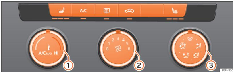
**Abb. 92** In der Mittelkonsole: Bedienelemente der manuellen Klimaanlage.
