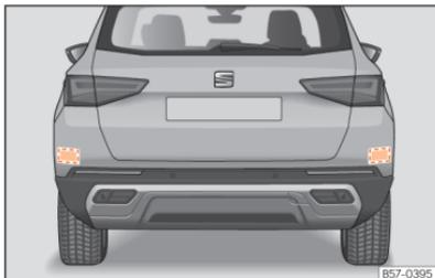
**Abb. 110** Bereich hinter dem Fahrzeug: Bereiche der Radarsensoren.
