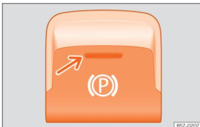
**Abb. 130** Im unteren Bereich der Mittelkonsole: Taste für die elektronische Parkbremse.
