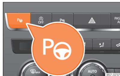
**Abb. 137** In der Mittelkonsole oben: Taster für Parklenkassistent.
