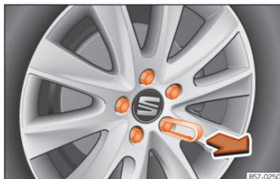
Abb. 217 Rad: Radschrauben mit Deckel.
