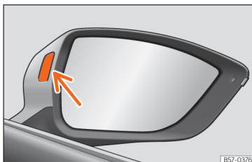
Abb. 151 Kontrollleuchte des Spurwechselassistenten.
