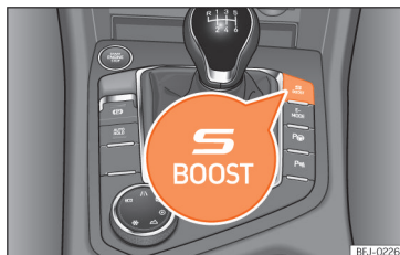
Abb. 128 Mittelkonsole: Taste S-BOOST
