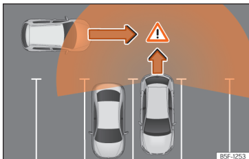
Abb. 174 Schematische Abbildung des Ausparkassistenten: Überwachter Bereich des ausparkenden Fahrzeugs.
