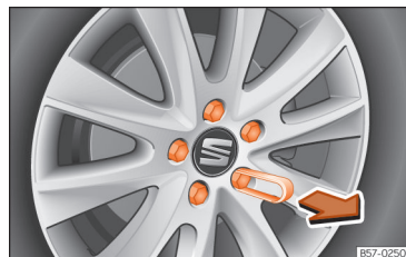
Abb. 250 Rad: Radschrauben mit Deckel.
