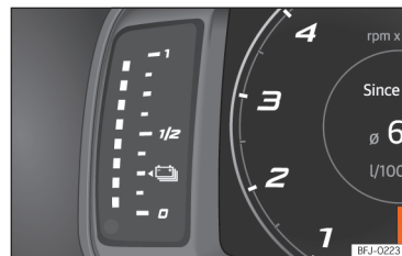
Abb. 8 Kombi-Instrument: Anzeige des Batterieladezustands.
