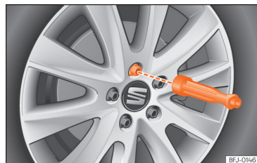
Abb. 256 Radwechsel: Radschrauben mit dem Schraubendrehergriff herausdrehen.
