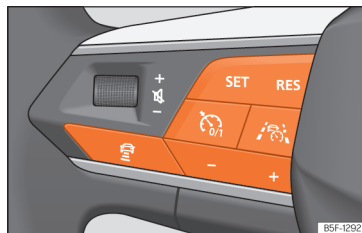
Abb. 149 Linke Seite des Multifunktionslenkrads.
