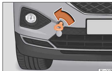
Abb. 225 Vorderer Stoßfänger rechts: Eingeschraubte Abschleppöse
