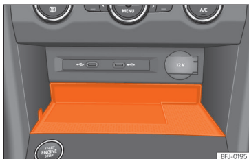
Abb. 192 In der Mittelkonsole: Aufnahme für die Mobiltelefonkopplung.
