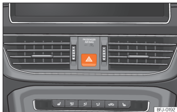
Abb. 49 Instrumententafel: Schalter für die Warnblinkanlage
