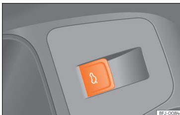
Abb. 77 In der Fahrertür: Taste zum Öffnen und Schließen der Heckklappe.
