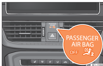
Abb. 33 Instrumententafel: Kontrollleuchte für abgeschalteten Beifahrerairbag.
