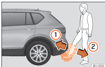
Abb. 78 Heckklappe mit sensorgesteuerter Öffnung (Easy Open).
