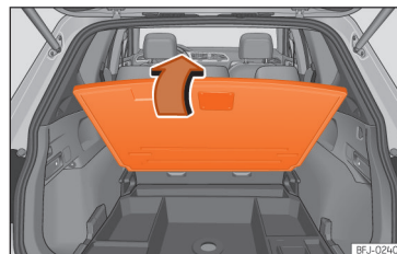
Abb. 198 Im Gepäckraum: Variabler Gepäckraumboden hochgeklappt.
