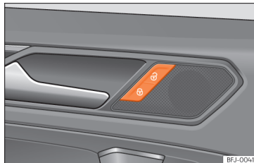
Abb. 70 In der Fahrtür: Zentralverriegelungstaster.
