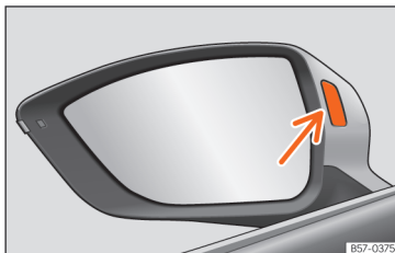
Abb. 150 Kontrollleuchte des Spurwechselassistenten.
