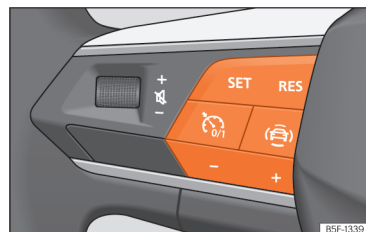
Abb. 137 Am Multifunktionslenkrad: Tasten zur Bedienung der Geschwindigkeitsregelanlage.
