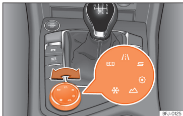
Abb. 127 Mittelkonsole: Drehknopf [Driving Experience button].
