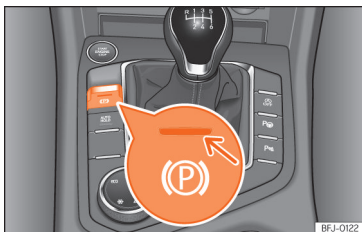
Abb. 154 Im unteren Bereich der Mittelkonsole: Taste für die elektronische Parkbremse.
