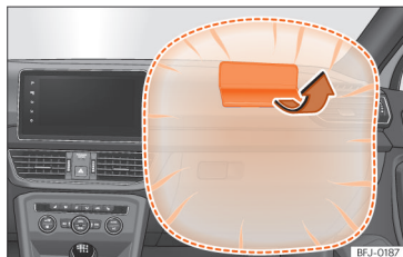
Abb. 31 Beifahrerairbag in der Instrumententafel
