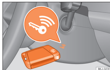
Abb. 119 Rechts an der Lenksäule: Notstart.
