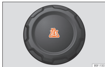
Abb. 236 Frontraum: Verschlussdeckel des Kühlmittel ausgleichsbehälters.
