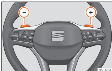
Abb. 125 Lenkrad: die Hebel für Automatikgetriebe.
