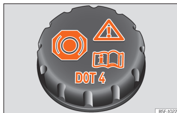
Abb. 237 Motorraum: Deckel des Bremsflüssigkeitsbehälters
