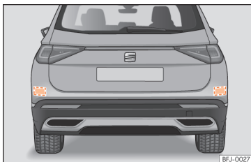
Abb. 134 Bereich hinter dem Fahrzeug: Bereiche der Radarsensoren.
