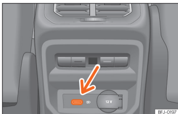
Abb. 185 Mittelkonsole hinten: USB-Anschlüsse mit Steckdosenfunktion.
