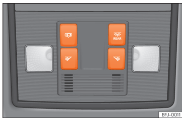
Abb. 106 Ausschnitt aus Dachhimmel: Innenbeleuchtung vorn.
