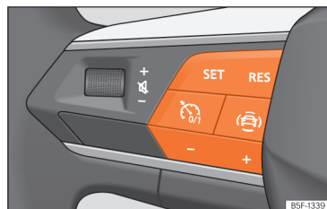
Abb. 138 Am Multifunktionslenkrad: Tasten zur Bedienung des Geschwindigkeitsbegrenzers.
