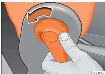
Abb. 90 Klappbare Beifahrersitzlehne entriegeln.
