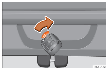
Abb. 79 Ausschnitt Gepäckraum: Notfallentriegelung.
