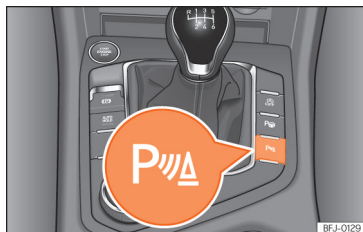
Abb. 158 Mittelkonsole: Taste für Einparkhilfe (je nach Ausführung).
