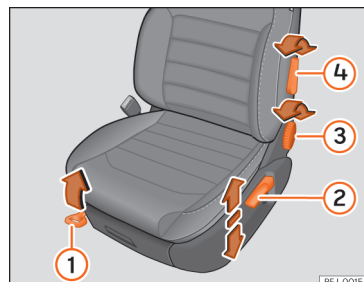
Abb. 87 Vordersitze: Manuelle Sitzverstellung.
