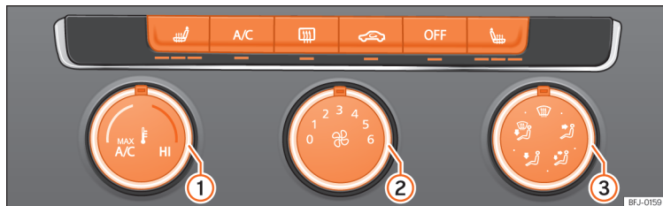
Abb. 113 In der Mittelkonsole: Bedienelemente der manuellen Klimaanlage.
