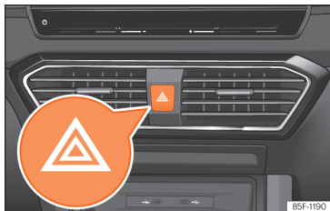
Abb. 52 Instrumententafel: Schalter für die Warnblinkanlage
