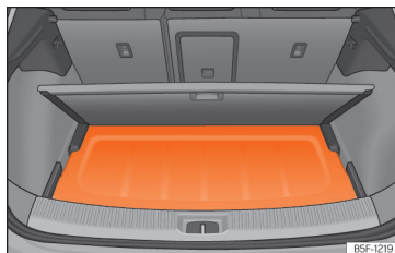
Abb. 176 Im Gepäckraum: Einsetzen der Gepäckraumabdeckung.
