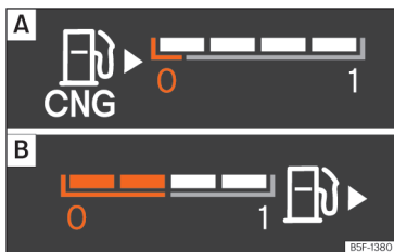
Abb. 8 Digitales Kombi-Instrument: A : Erdgasvorratsanzeige. B : Benzinvorratsanzeige
