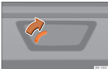
Abb. 83 Ausschnitt Gepäckraum: Notfallentriegelung (Leon Sportstourer).
