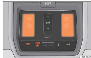
Abb. 103 Ausschnitt aus Dachhimmel: Innenbeleuchtung vorn.
