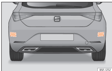
Abb. 125 Bereich hinter dem Fahrzeug: Bereiche der Radarsensoren.
