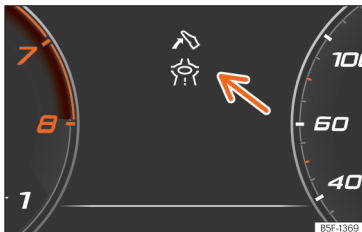
Abb. 65 Anzeige des Assistenten für eine ökologische Fahrweise (schematische Darstellung).
