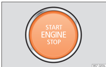
Abb. 133 Im unteren Teil der Mittelkonsole: Starterknopf.
