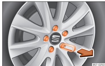
Abb. 34 Rad: Radschrauben mit Deckel.
