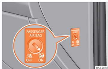
Abb. 16 Schlüsselschalter zum Ein- und Abschalten des Beifahrerairbags.
