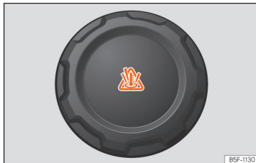
Abb. 193 Motorraum: Deckel des Motorkühlmittelausgleichsbehälters.
