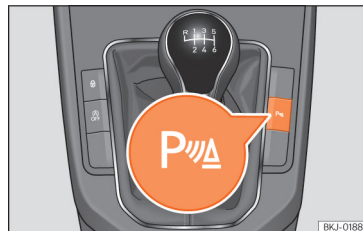
Abb. 167 Mittelkonsole: Taste für Einparkhilfe (je nach Ausführung).
