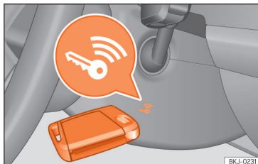
Abb. 134 Rechts an der Lenksäule: Notstart.
