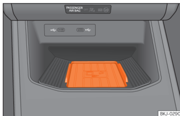
Abb. 130 In der Mittelkonsole: Aufnahme für die Mobiltelefonkopplung.
