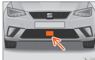
Abb. 142 Am vorderen Stoßfänger: Radarsensor.
