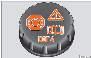
Abb. 194 Motorraum: Deckel des Bremsflüssigkeitsbehälters.
