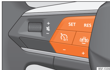
Abb. 149 Am Multifunktionslenkrad: Tasten zum Bedienen des Geschwindigkeitsbegrenzers
