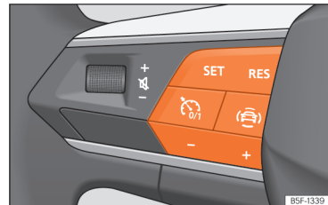
Abb. 148 Am Multifunktionslenkrad: Tasten zum Bedienen der Geschwindigkeitsregelanlage
