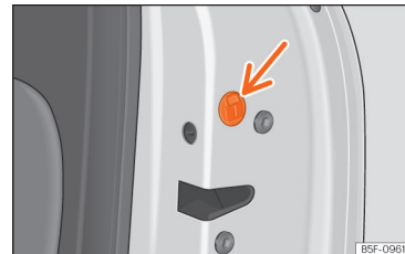
Abb. 88 Notfallsperre der Tür.
