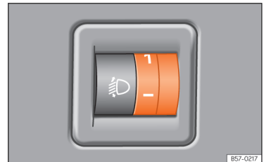
Abb. 99 Neben dem Lenkrad: Regler für die Leuchtweitenregulierung.
