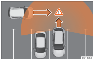
Abb. 164 Schematische Abbildung des Ausparkassistenten: Überwachter Bereich des ausparkenden Fahrzeugs.
