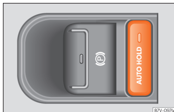
Abb. 267 Ansicht der Mittelkonsole: Taste für Auto Hold.
