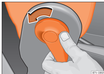
Abb. 139 Klappbare Beifahrersitzlehne entriegeln.
