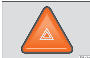
Abb. 117 Instrumententafel: Schalter für Warnblinkanlage.
