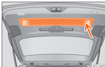
Abb. 103 Offene Heckklappe: Griffmulde zum Zuziehen.
